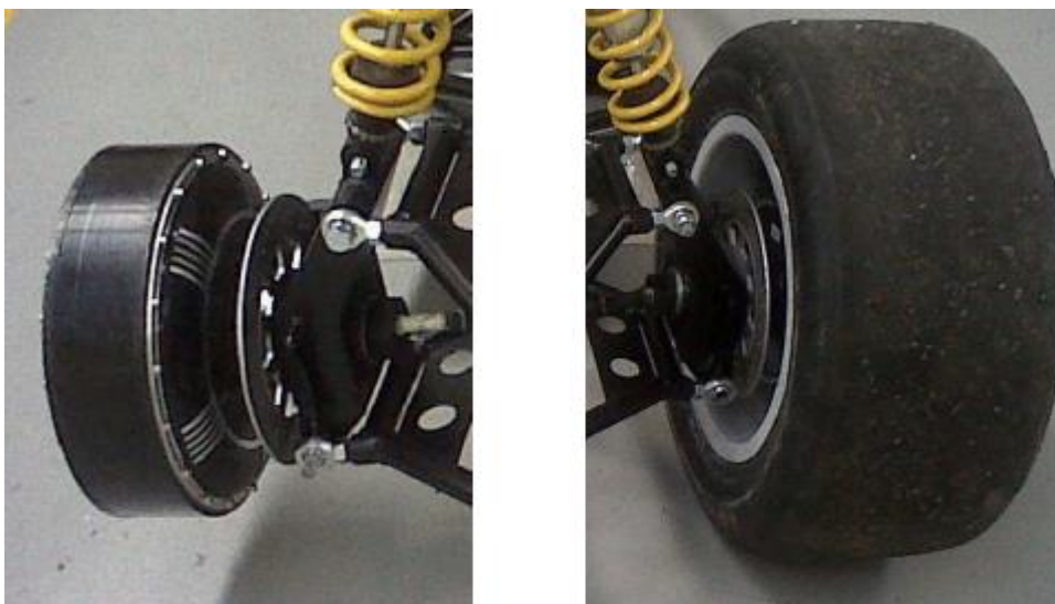
Figura 2.2: Detalle de los motores del vehículo FOX [6]
