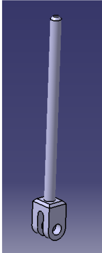
Figura 3.38 Barra de distribución.
