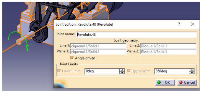
Figura 4.34 Revolute entre cigüeñal y bloque fijo.
