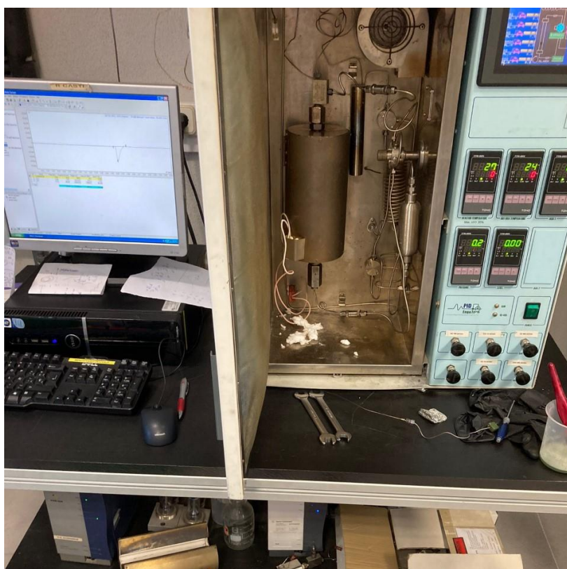
Figura 3.5. Reactor continuo de lecho fijo.
