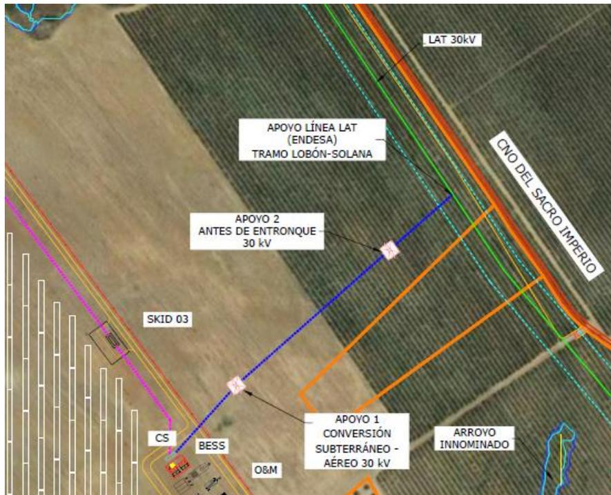
Figura 8-1 Tramos de la línea de evacuación 30 kV
