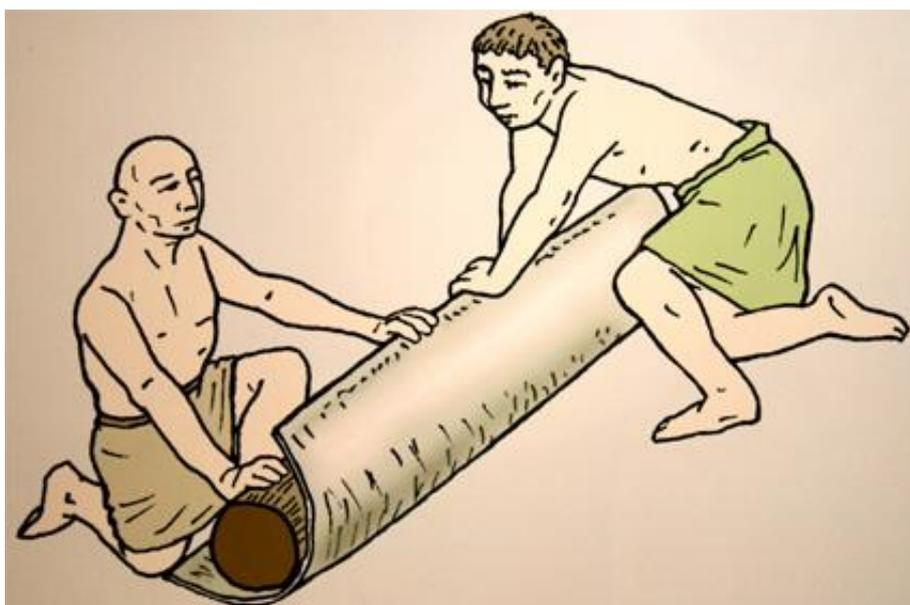
Figura 2-4. Curvado de lámina de plomo
