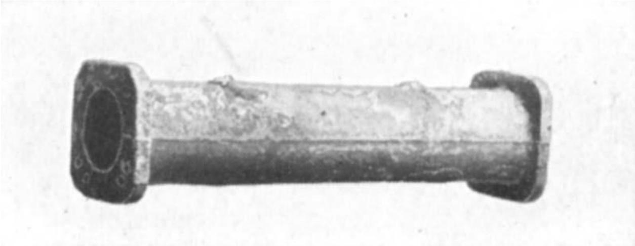
Figura 2-6. Tubería de fundición del Palacio de Versalles
