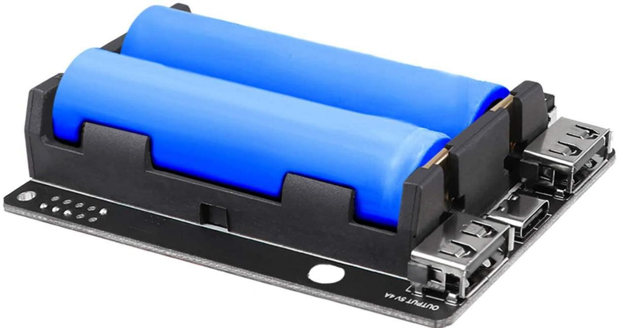
Ilustración 71: Fuente de alimentación UPS ininterrumpible Innovateking-EU Raspberry Pi con baterías 18650
