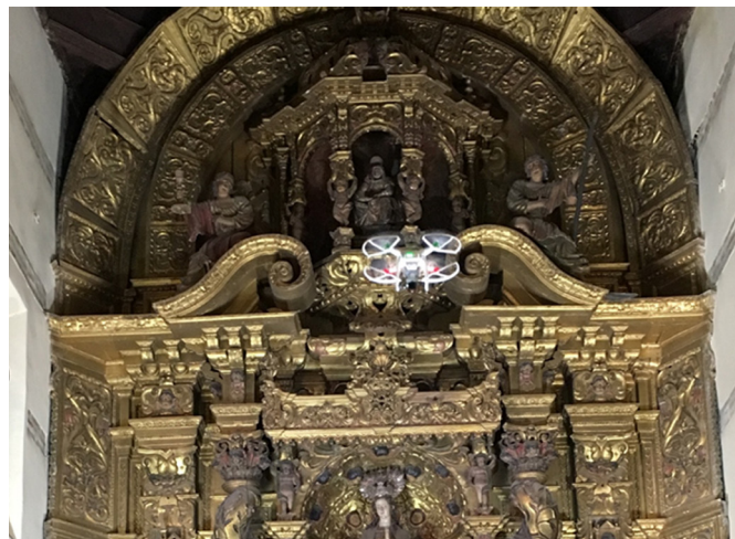
Fig. 5 Vuelo de dron para la toma de imágenes en zonas elevadas
