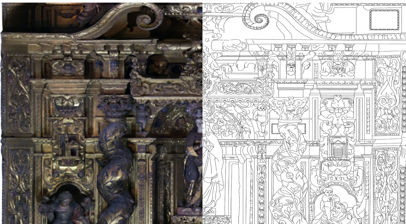
Fig. 8 Proceso de trazado a partir de ortofoto
