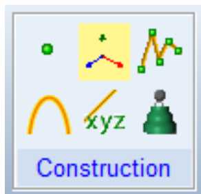
Figura 3-3. Herramienta 'Marker' (resaltada en amarillo) empleada para la definición de los centros de masa de los elementos.
