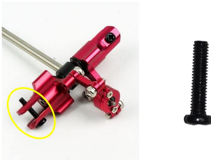
Figura 7-2. Tornillo M2 de sujeción de la pala.
