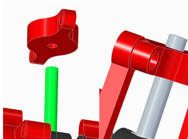
Figura 2-4. Relación de alineación axial del elemento ‘cabeza’ con la pieza ‘mástil fino’ (izq) y resultado del establecimiento de todas las relaciones de la pieza ‘cabeza’ (dcha).
