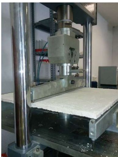
Figura 9. Ensayo de rotura de las placas yeso-madera en laboratorio según norma UNE-EN 14246. Fuente: Elaboración propia.
