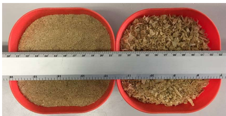
Figura 2. Residuos de madera (serrín y virutas) empleados en la investigación. Fuente: Elaboración propia.
