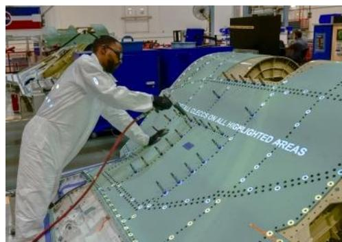
Figura 3-2. Aplicación de realidad aumentada basada en proyección tradicional para ayudar al operario en el proceso de ensamblaje.
