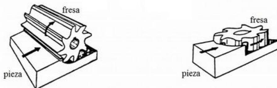
Figura A. 13. Fresado cilíndrico normal (izquierda) y fresado frontal (derecha)
