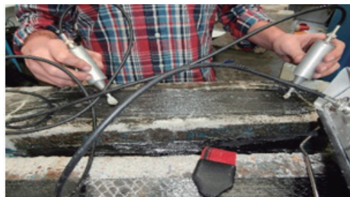
Fig. 9. Medición ultrasónicos método indirecto Fuente: elaboración propia.
