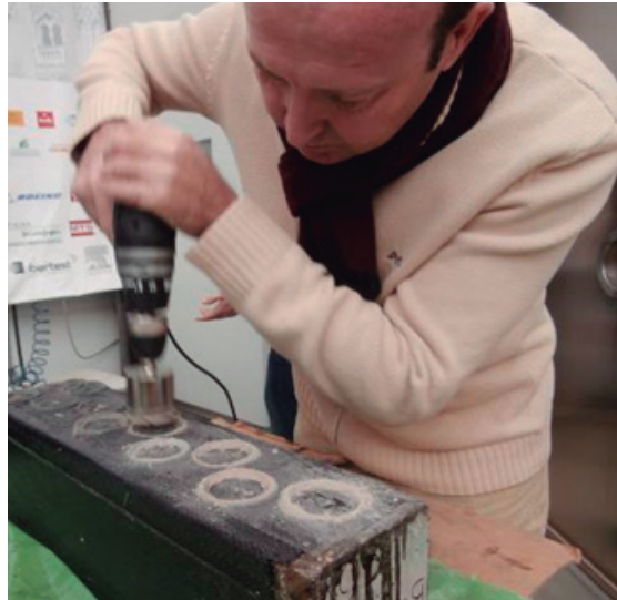
Fig. 5. Corte circular diferentes bandas de FRP Fuente: elaboración propia.
