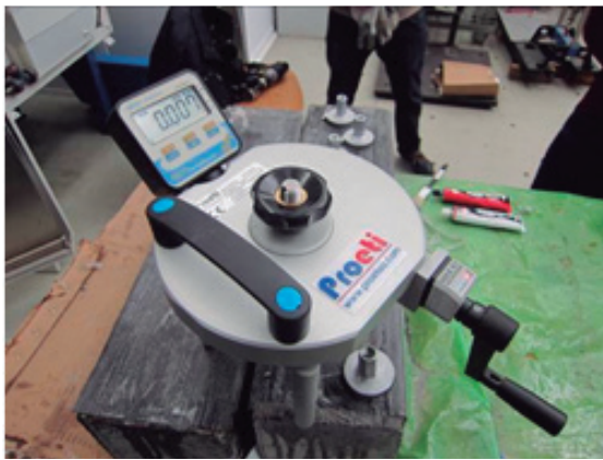
Fig. 6. Equipo para ensayo pull-off Fuente: elaboración propia.
