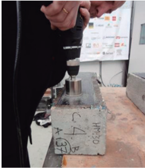
Fig. 4. Corte circular sobre FRP Fuente: elaboración propia.
