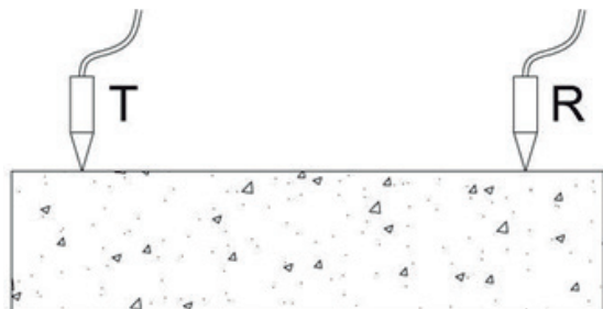
Fig. 8. Medición ultrasónicos método indirecto Fuente: Tomado de [19].
