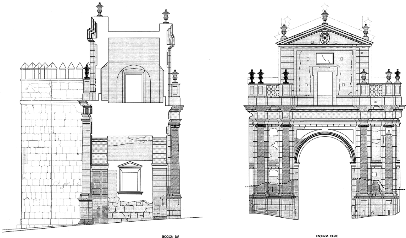
Fig. 6. Estado previo. Indicadores visuales de alteración en fachada oeste y sección sur
