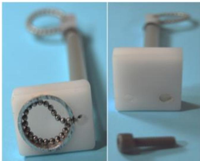
Caja de almacenamiento y fijación de la cadena de esferas
