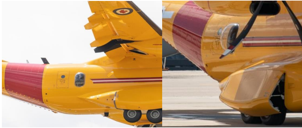
Figura 5-63. Detalle de ventana de tipo burbuja en el C295 versión FWSAR
