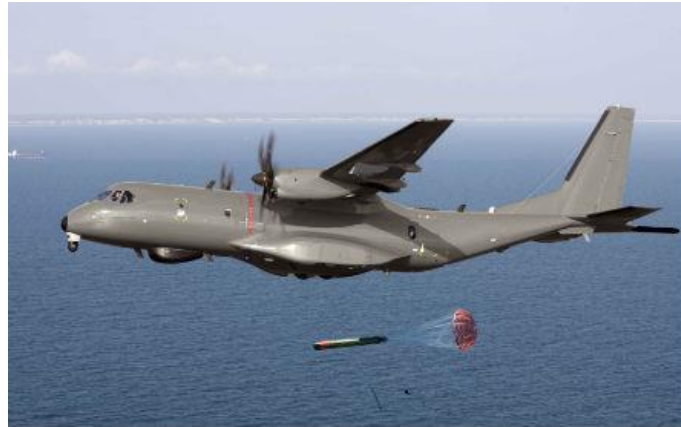
Figura 2-13. C295 ASW chileno durante el lanzamiento de un torpedo. (Fuente: Airbus)
