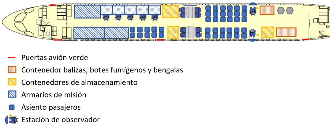
Figura 5-31. A220 MPA en configuración AIM2S (MPA + ASW + C4ISR) y transporte pasajeros o tropa
