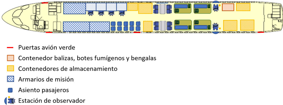
Figura 5-29. A220 MPA en configuración MPA + C4ISR + MEDEVAC
