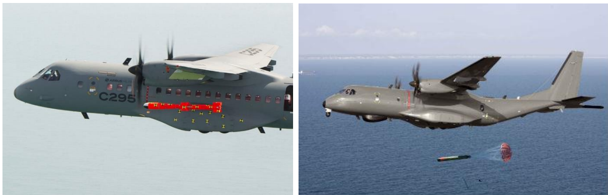
Figura 5-60. Desarrollo de pruebas en vuelo del C295 para misil instrumentalizado (izquierda) y torpedo MK-46 para la versión chilena (derecha). (Fuente: Airbus)
