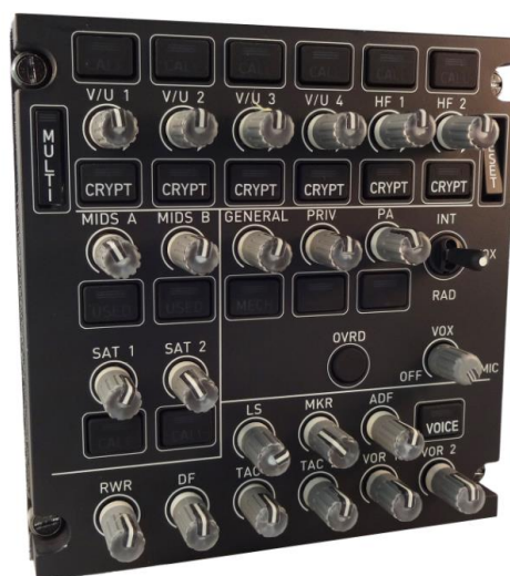
Figura 5-9. Panel de control del sistema de control de audio del A400M fabricado por la española TecnoBit. (Fuente: TecnoBit.com)
