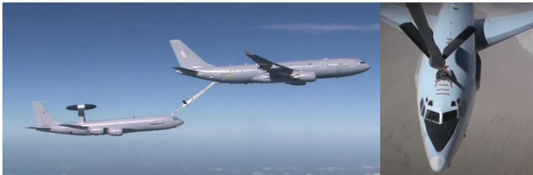
Figura 5-51. A330 MRTT repostando a un AWACS mediante el sistema UARRSI. (Fuente: Airbus)
