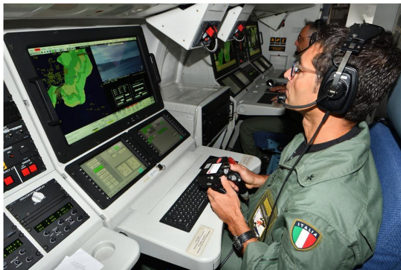
Figura 2-3. Un operador italiano controla el sensor electro-óptico desde una de las consolas. (Fuente: Leonardo Company)
