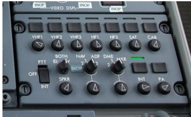
Figura 5-8. Panel de control de audio del A220. (Fuente: [61])
