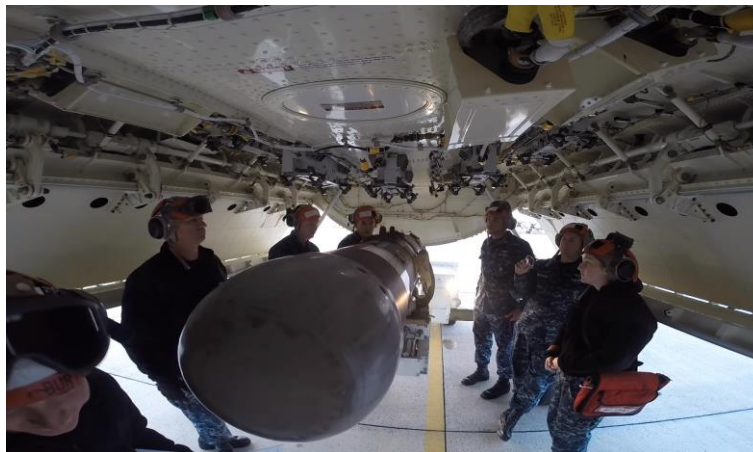
Figura 5-54. Bahía de bombas de Boeing P-8 Poseidon con bodega de armas abierta durante la instalación de torpedo MK-54. (Fuente: Mallory Burton en Youtube.com)
