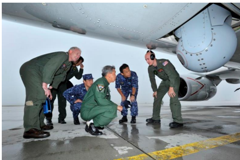
Figura 2-7. Un marino de la US Navy explica a marineros de la Armada japonesa el sistema retráctil de la torreta situada bajo el fuselaje del P-8 (Fuente: US Navy)
