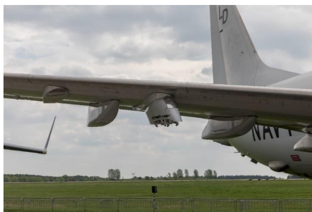
Figura 5-58. Ejemplo de punto duro con pilón desmontado (parte izquierda de la imagen) y pilón montado a la espera de armamento (parte central de la imagen)
