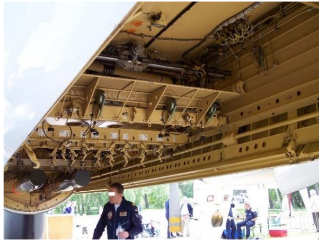
Figura 2-10. Bodega de armas del Atlantique 2 equipado con torpedos. (Fuente: Wikimedia Commons)
