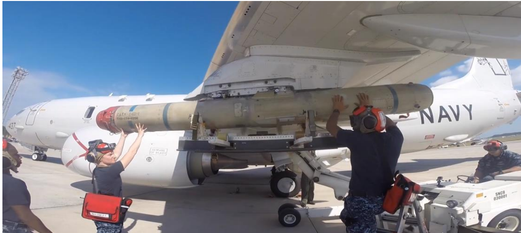
Figura 5-59. Instalación de misil Harpoon en pílón del Boeing P-8 Poseidon
