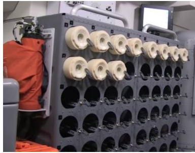
Figura 5-23. Armario modular para sonoboyas. (Fuente: Canal USA Military Channel Youtube.com)
