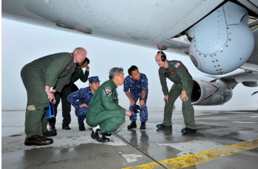
Figura 5-67. Un marino de la US Navy explica a marinos de la Armada japonesa el sistema retráctil de la torreta situada bajo el fuselaje del P-8. (Fuente: US Navy)
