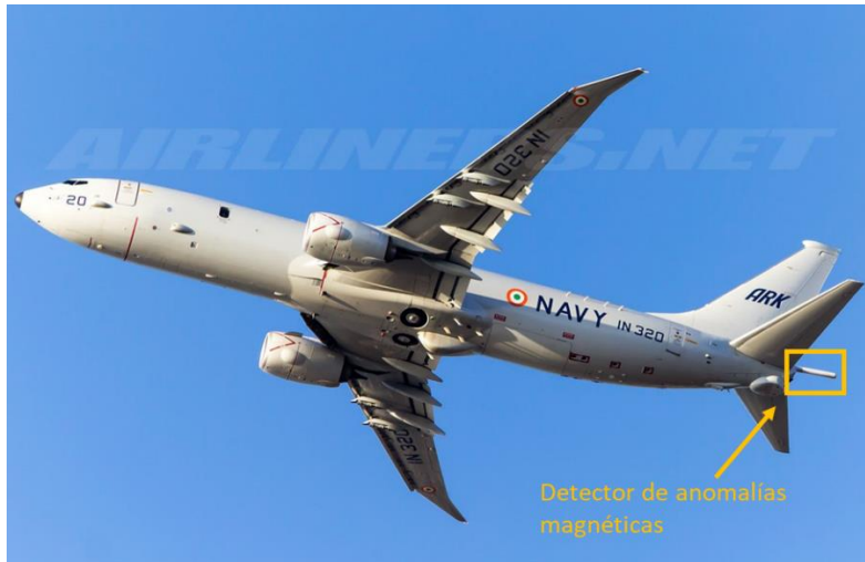
Figura 5-68. Detalle de localización del MAD en Boeing P-8I (Versión India). (Fuente: airliners.net)
