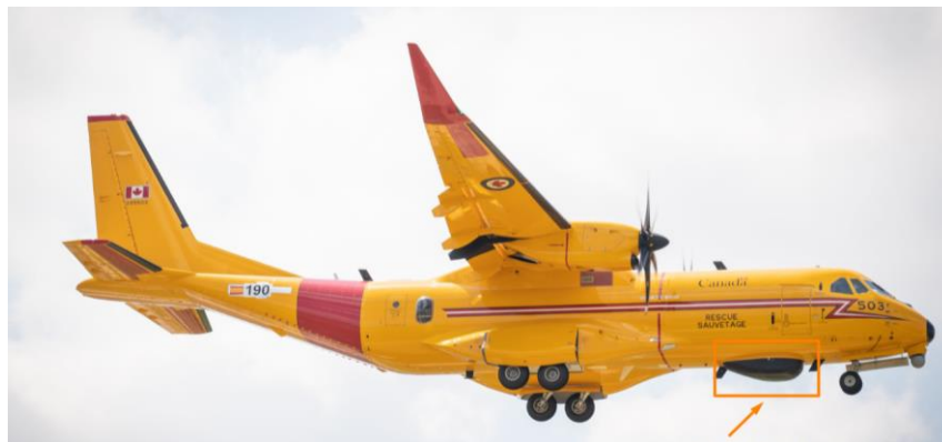
Figura 5-66. Detalle de antena del radar ELTA ELM-2022 instalada en el C295 versión FWSAR. (Fuente: Airbus)
