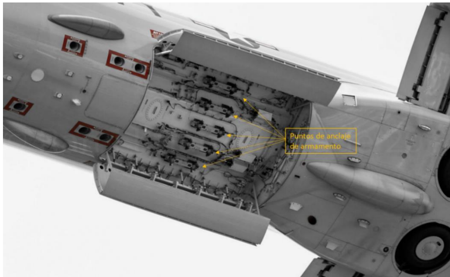
Figura 5-57. Detalle bahía de bombas del Boeing P-8 Poseidon. (Fuente: Rami Khanna-Prade en Flickr)
