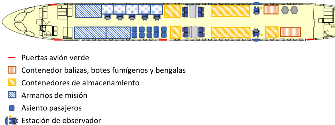
Figura 5-30. A220 MPA en configuración AIM2S (MPA + ASW + C4ISR)
