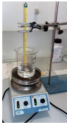
Figura 19. Dispositivo para la agitación y calentamiento del carbonato de sodio y precipitador.
