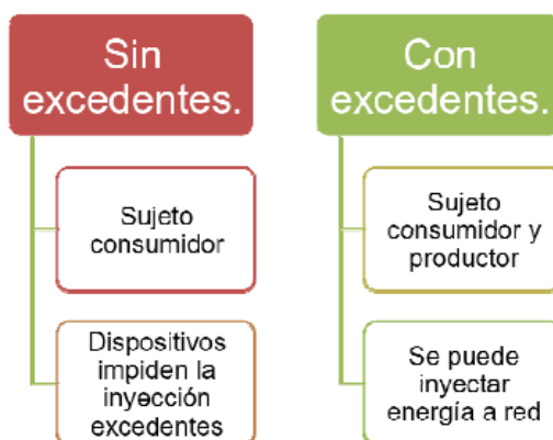
Figura 3. Resumen de los tipos de instalaciones fotovoltaicas de autoconsumo desde el punto de vista de los excedentes.
