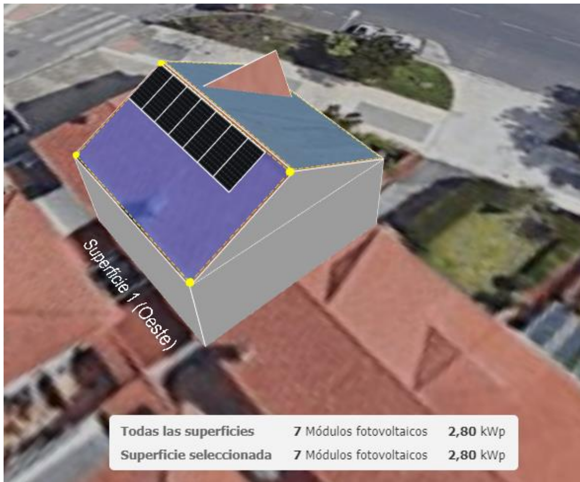
Figura 59. Ilustración de los paneles fotovoltaicos colocados sobre la cubierta obtenido con el programa SunnyDesign.
