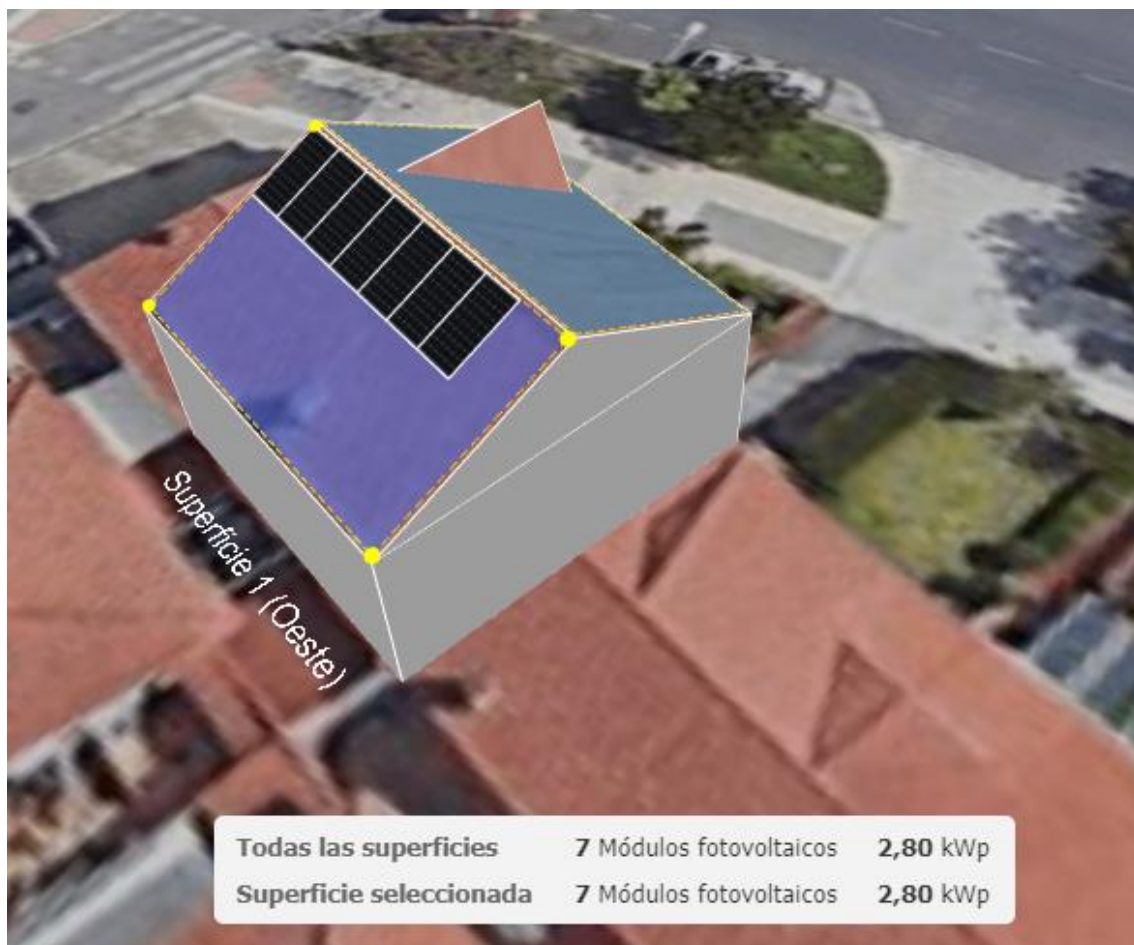
Figura 26. Ilustración con la ubicación de los paneles desarrollada con Sunny Design.
