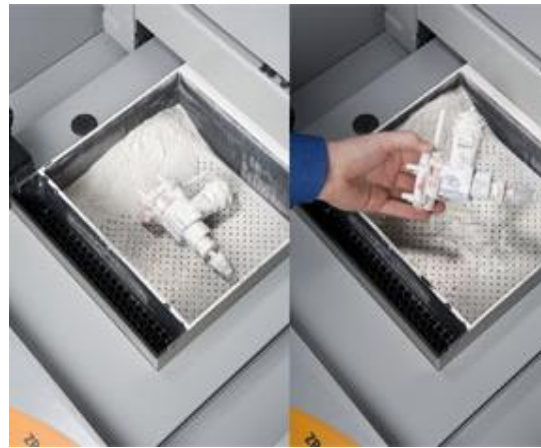
(Fig. 24) Diagrama y pieza realiza por impresión SLS
