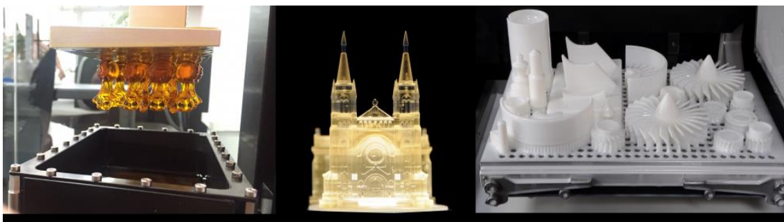
(Fig. 23) Piezas impresas por medio de Estereolitografía – Imagen Cosomo SLL
