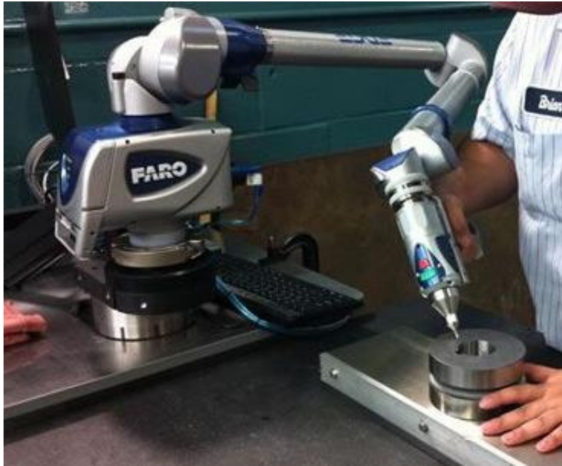
(Fig. 8) Scanner de contacto – Imagen 3Dalia
