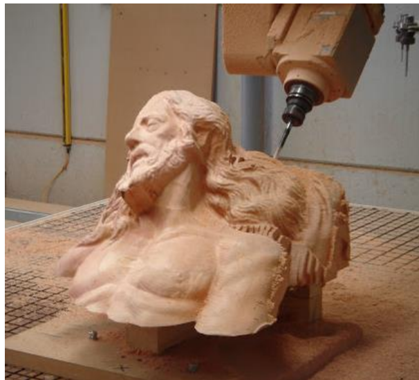
(Fig. 19) Cnc trabajando sobre embón de madera Imagen WordArt
