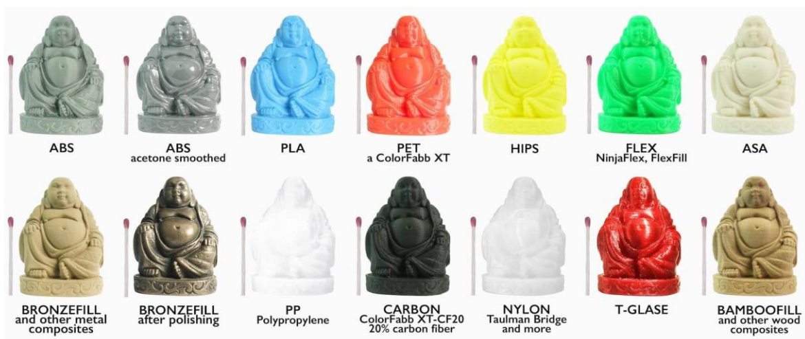
(Fig.21) Diferentes materiales para impresión 3D – Imagen de Prusa 3D
