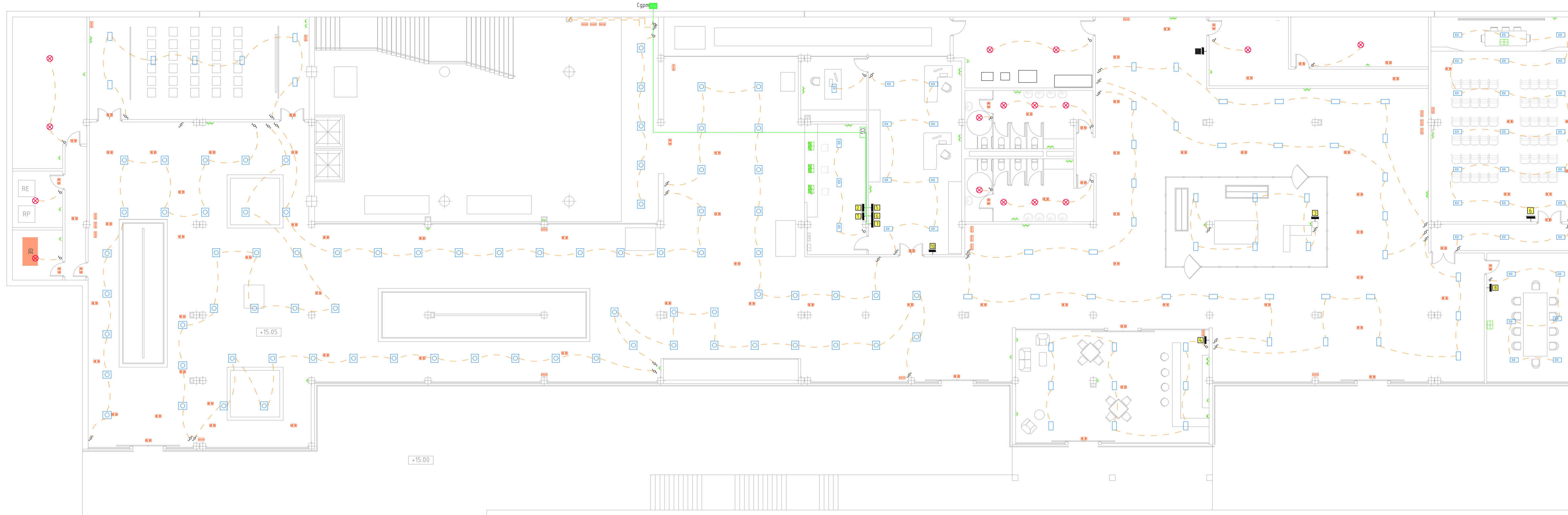
INSTALACIÓN DE ELECTRICIDAD. PLANTA BAJA _ Escala 1/150.
