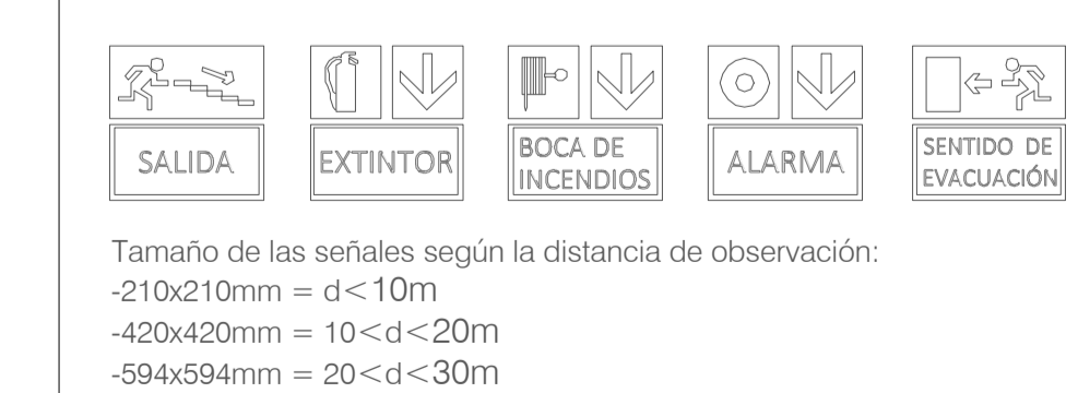
SEÑALIZACIÓN NORMALIZADA A COLOCAR EN EL EDIFICIO
