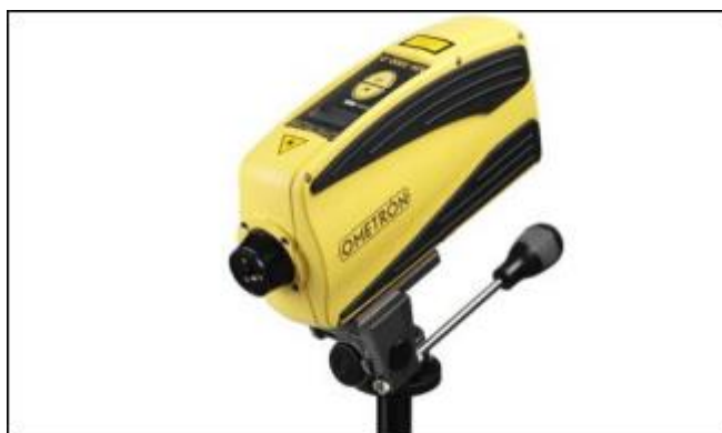
Figura 3-9. Vibrómetro láser utilizado en los ensayos. Tipo 8338. Fabricante: Brüel & Kjær. Proveedor: Ometron.
