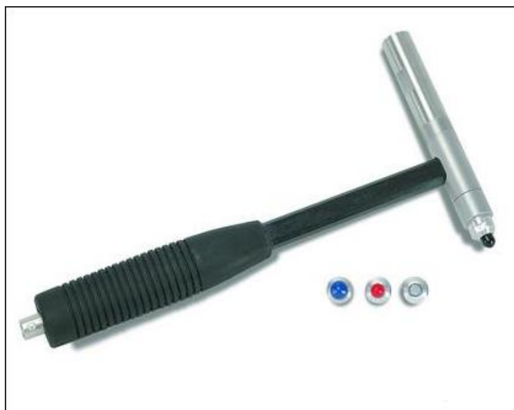
Figura 3-10. Martillo de impactos utilizado en los ensayos. Modelo 086C02. Fabricante: PCB Piezotronics.
