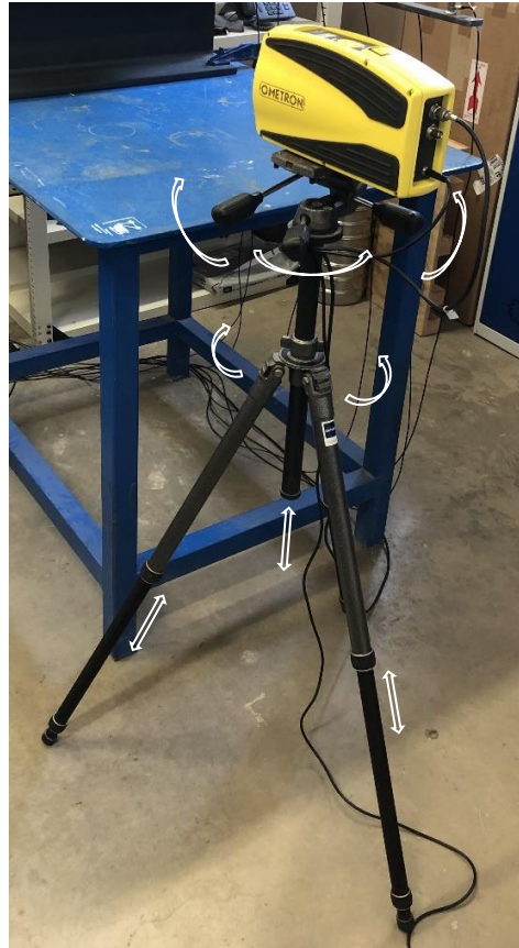
Figura 3-16. Trípode utilizado en los ensayos para el vibrómetro laser con indicación de grados de libertad. Modelo G1220. Fabricante: Gitzo.
