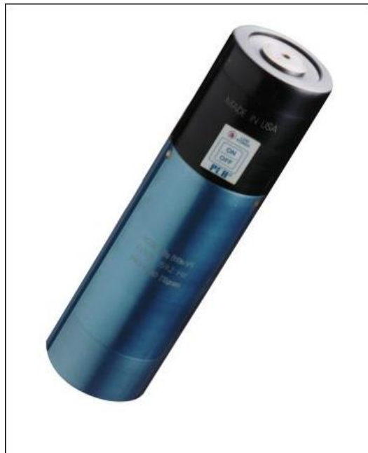
Figura 3-11. Calibrador utilizado en los ensayos. Modelo 394C06. Fabricante: PCB Piezotronics.
