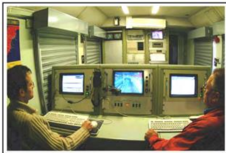
Figura 27. Laboratorio en un tren auscultador. Fuente [25]
