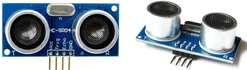
Figura 2-16. Sensor de ultrasonidos HC-SR04.
