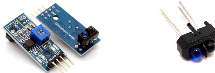
Figura 2-14. Módulo TCRT5000 (izquierda) y sensor aislado (derecha).
