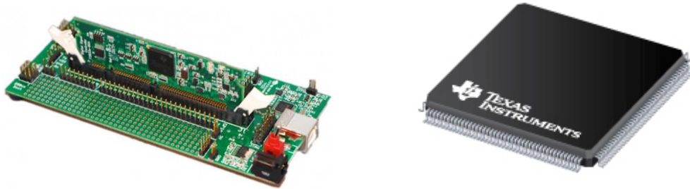
Figura 2-8. Estación de acoplamiento (izquierda) y TSM320F28335 aislado (derecha).
