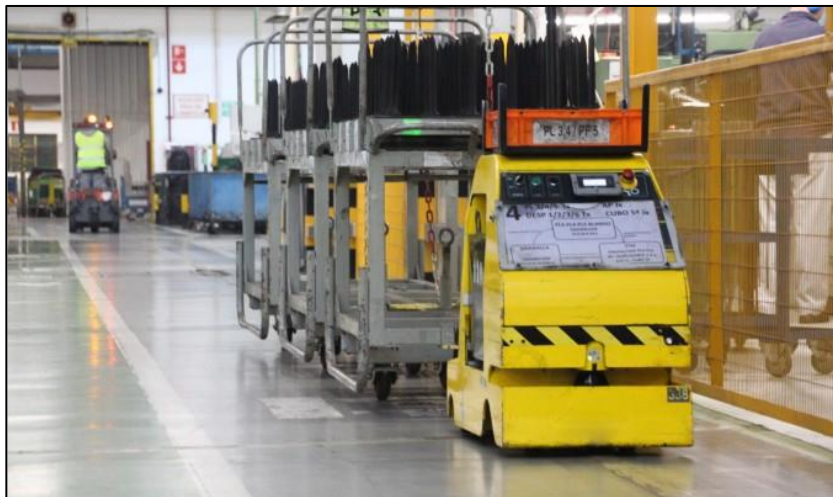
Figura 1-1. Ejemplo de AGV en la factoría Renault España , en Sevilla.
