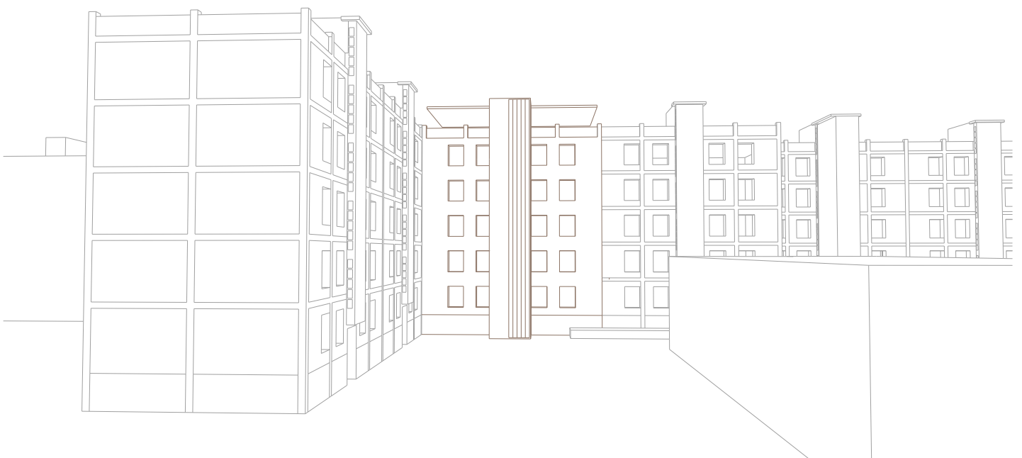
Fig. 89: Alzado del edificio tras la rehabilitación del núcleo de escaleras y ascensor e implantación de la pérgola. Fuente: Elaboración propia.
