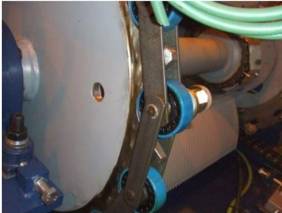
Figura 17. Engrane cadena de rodillos-rueda dentada (4)
