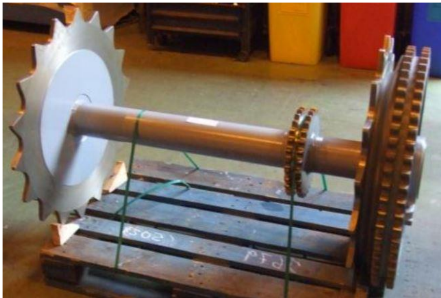
Figura 16. Rueda dentada del sistema de tracción (4)
