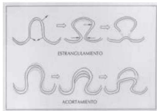
Figura 21. Mecanismo de corte y abandono de meandros según Pedraza (1996).
