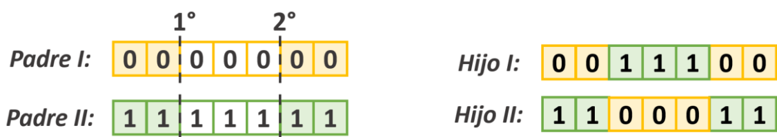
Figura 15: Cruce basado en dos puntos de cromosomas codificados en binario.
