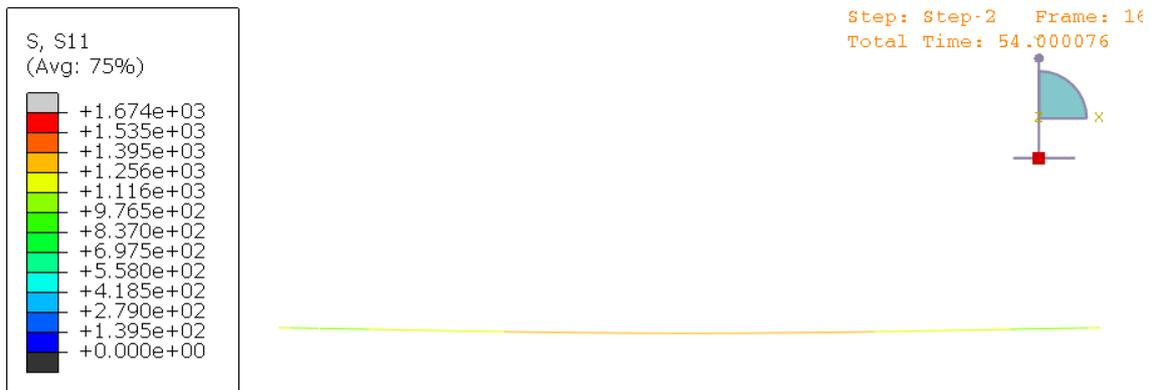
**Figura 90.** Estado tensional de la armadura pretensada a los 54 segundos. S11: Tensión longitudinal en MPa.
