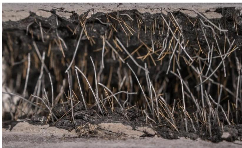
**Figura 127.** Fibras de acero larga y corta reforzando el hormigón.
