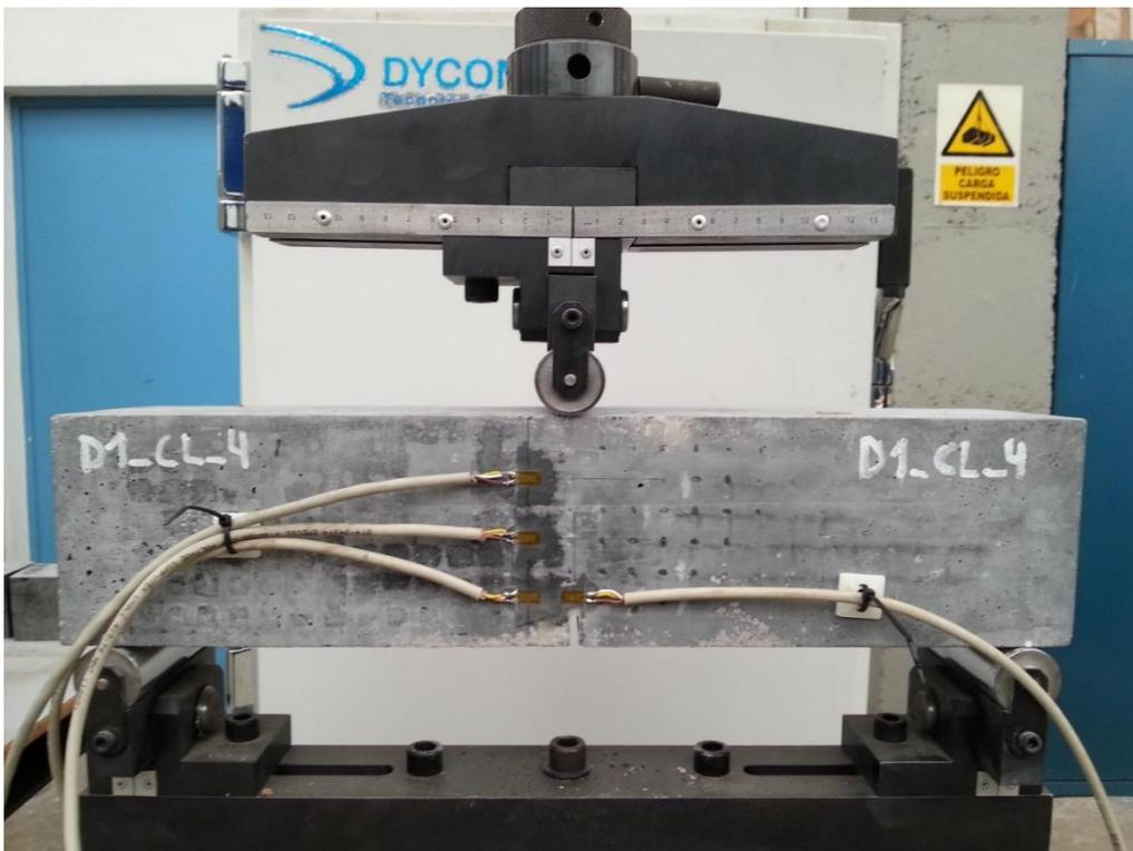
**Figura 10.** Ensayo de flexión en tres puntos sobre probeta de hormigón de ultra-altas prestaciones.
