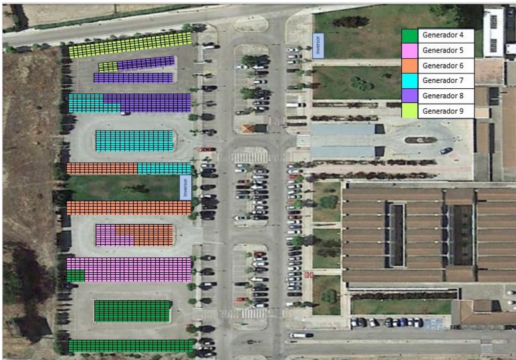
Figura 16. Distribución de módulos en zona de aparcamientos 1 del Hospital. Ubicación sala de inversores.
