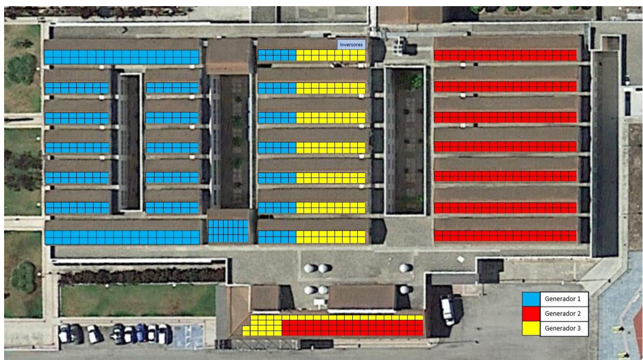
Figura 12. Distribución de módulos en cubiertas del Hospital. Ubicación sala de inversores.
