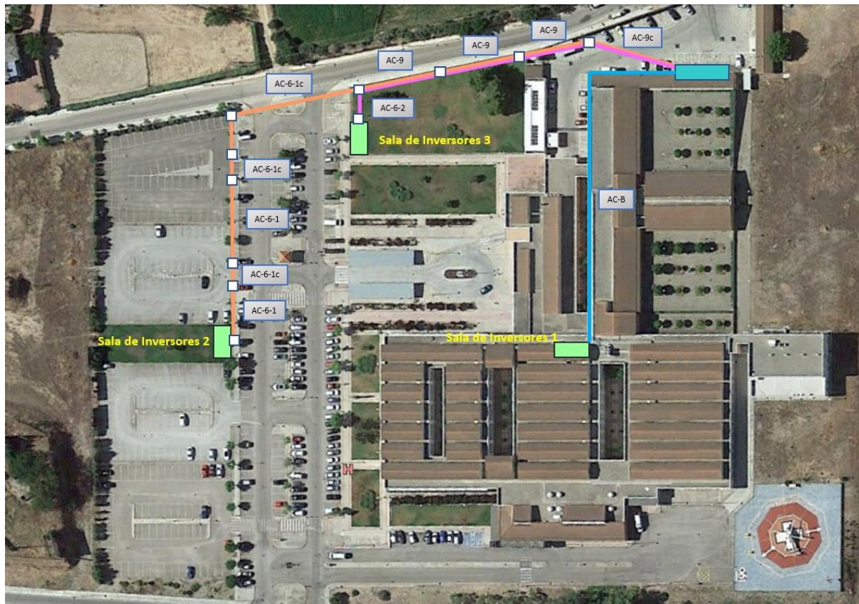
Figura 33. Canalización BT AC, conexión inversores con el CT Hospital.
