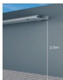
Figura 34. Canalización en bandeja metálica perforada en la red de BT AC.
