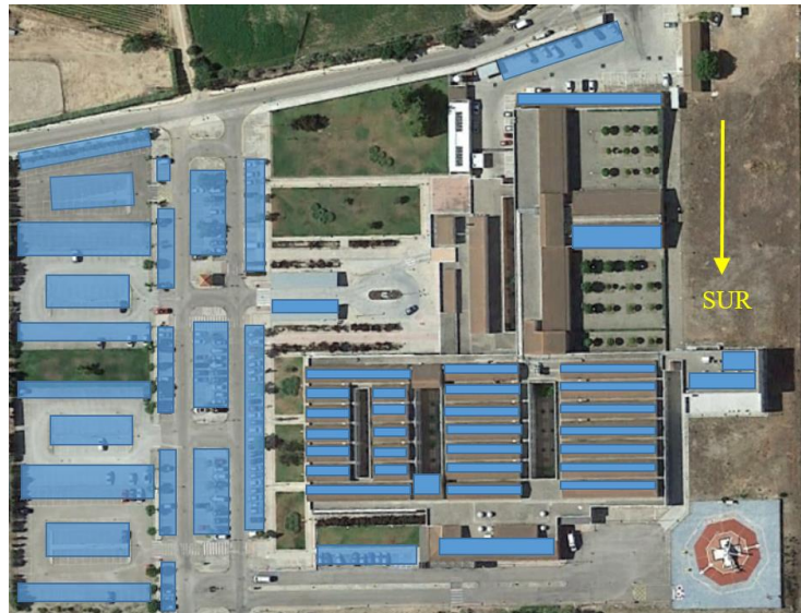
Figura 2. Posibles zonas de instalación de módulos fotovoltaicos.
