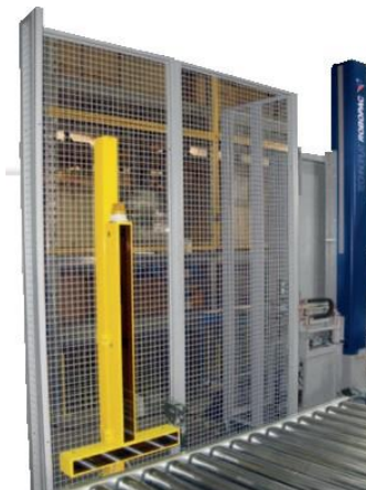
Ilustración 52. Barrera de seguridad función muting.
