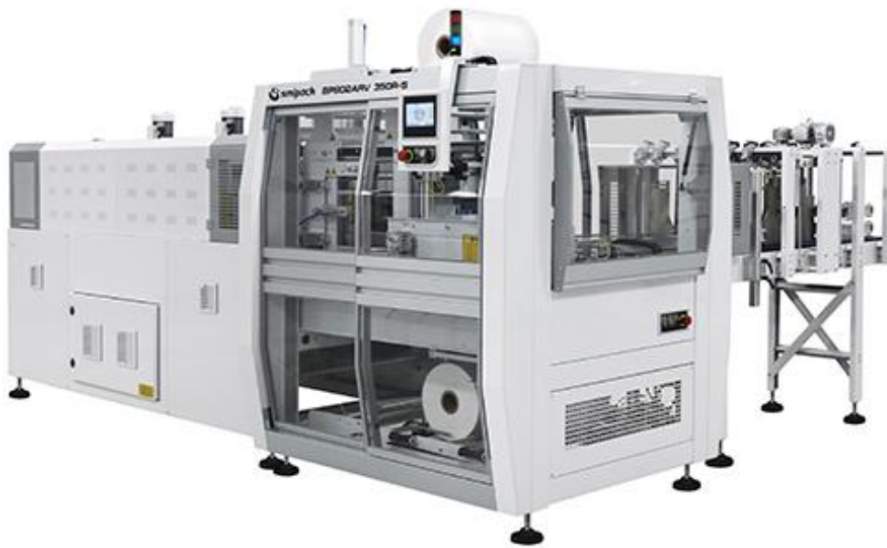
Ilustración 4. Máquina formadora packs con horno de retractilado. [Fuente: smipack.com]
