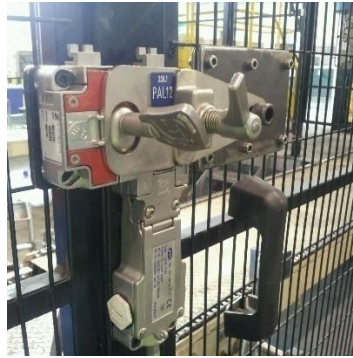
Ilustración 10. Dispositivo de enclavamiento por transferencia de llave.
