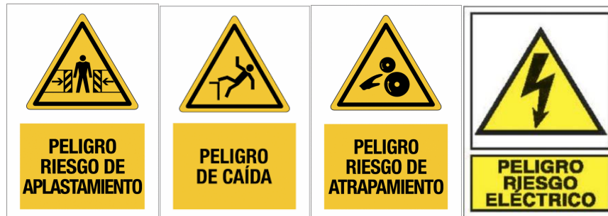
Ilustración 14. Pictogramas señalización riesgos entrada palets y cinta transportadora.
