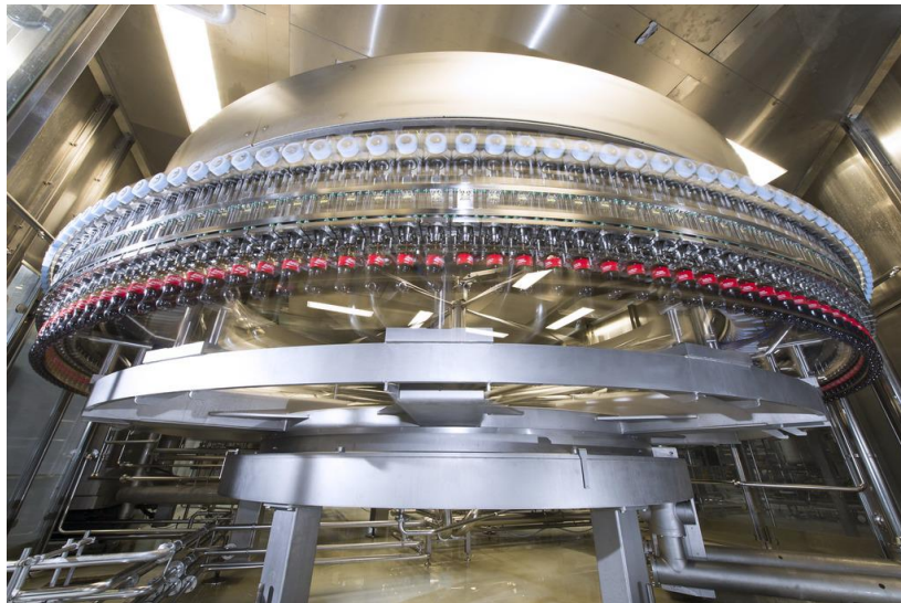
Ilustración 3. Máquina llenado botellas PET. [Fuente: krones.com]
