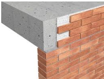
Imagen 31: visualización de emparchado. Fuente: Sulaplanet.
