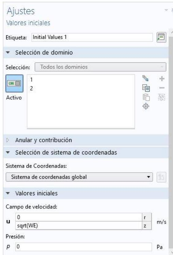
Figura 3.12: Condiciones iniciales de presión y velocidad
