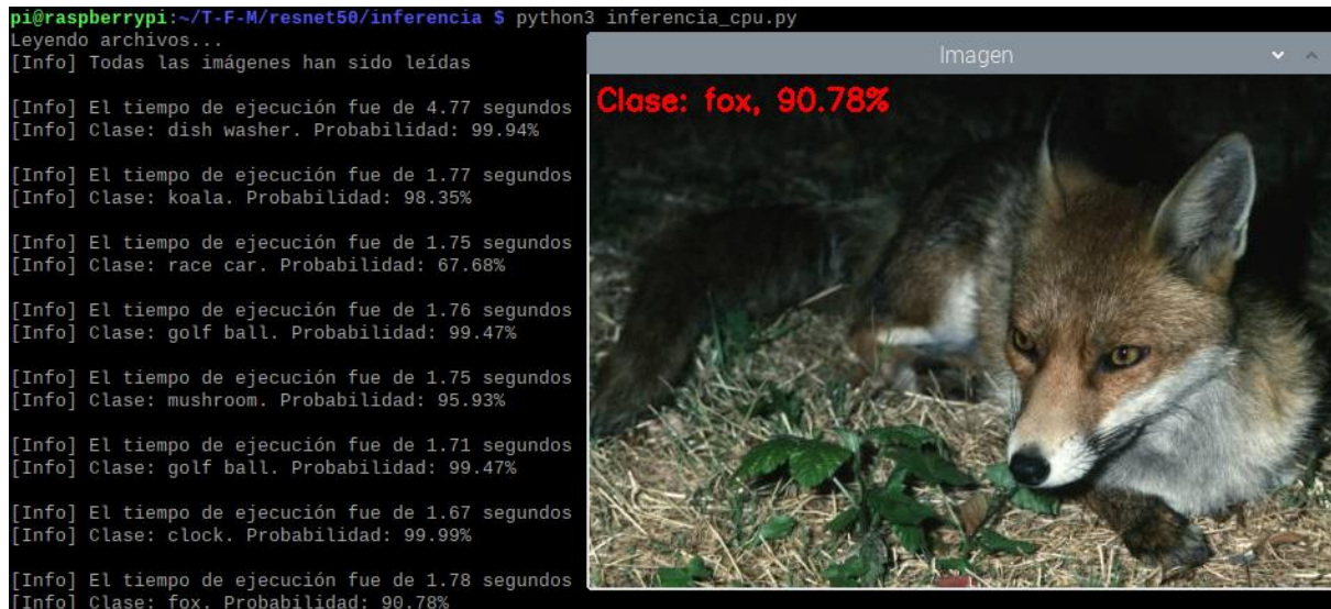
Figura 69: Resultados con la Raspberry Pi de la red ResNet50
