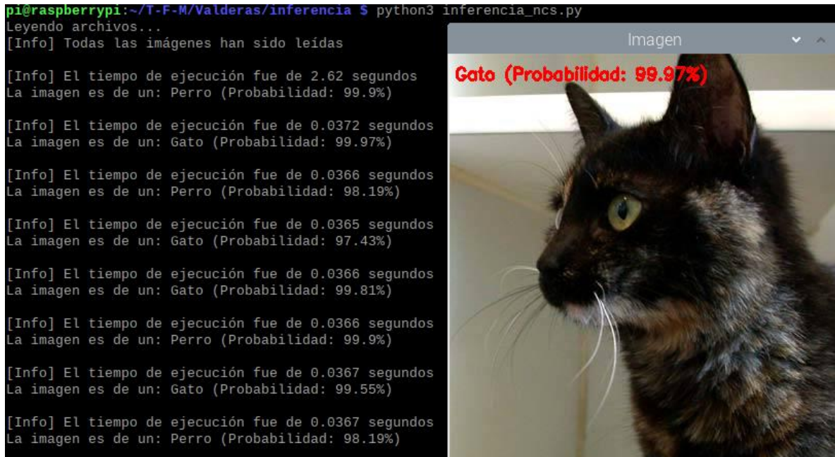
Figura 44: Resultados con la Raspberry Pi y el NCS del clasificador de perros vs gatos
