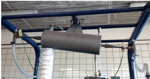
Es el equipo más elevado dentro de la estructura de la planta. Condensa el vapor procedente de la torre de platos al hacerlo circular por un serpentín sumergido en agua fría. Mediante el rotámetro (válvula V14) se regula el caudal con el que se renueva el agua yacente en el condensador.
