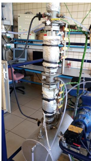
Es una estructura de cristal larga compuesta por dos cuerpos, uno superior y otro inferior, unidos por un tubo corto de acero que además sirve de entrada a la corriente de mezcla de entrada al sistema. Cada cuerpo contiene cuatro platos perforados de arriba abajo aparejados con los termopares del T1 y T8, con el mismo orden que el de los platos.
