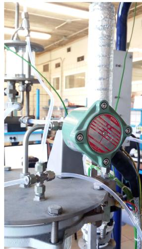
Figura 2-4. Válvula de reflujo
