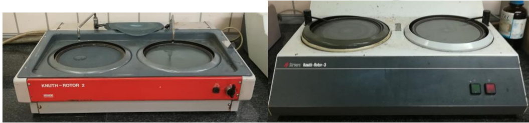
Ilustración 64. Pulidoras utilizadas para el desbastado de la pieza
