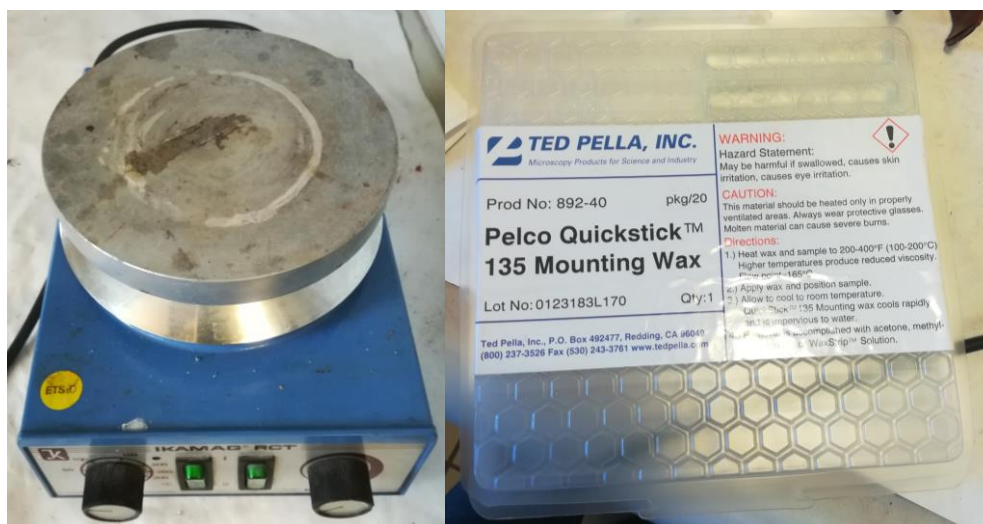
Ilustración 60. Agitadora Ikamag-RCT utilizado para la fusión de la cera y su introducción en la muestra
