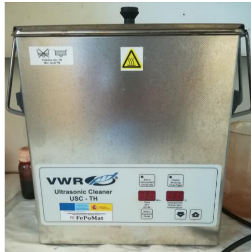
Ilustración 54. Baño de ultrasonidos VWR Ultrasonic Cleaner USC-TH
