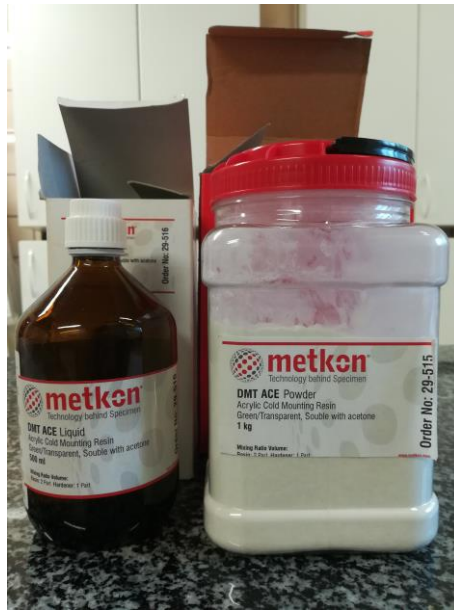
Ilustración 62. Componentes Metkon utilizados para la formación de la resina
