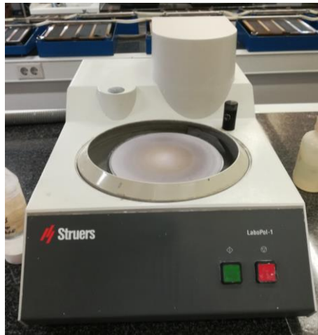
Ilustración 65. Pulidora utilizada para el pulido final de la sección de la pieza cortada
