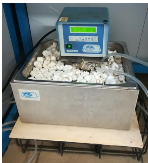
Ilustración 57. Dispositivo para refrigeración a temperatura constante Selecta Digiterm 200
