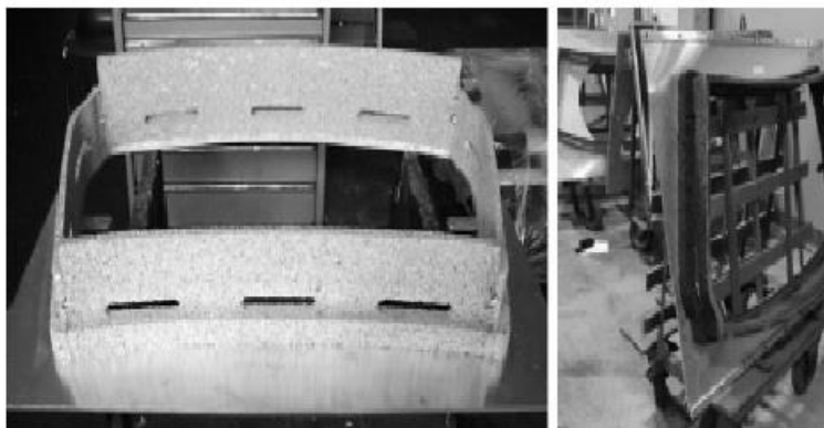
Ilustración 2. Herramienta de sujeción por vacío realizada en espuma de aluminio [LEF 2008]
