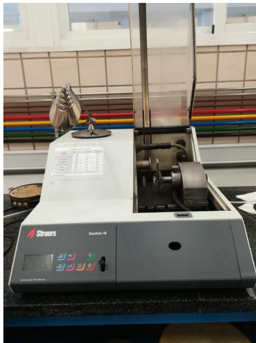
Ilustración 63. Cortadora Struers Secotom-10
