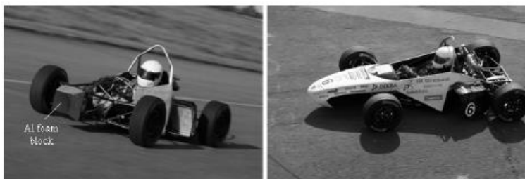
Ilustración 3. Coche de carreras con elemento protector realizado en espuma de aluminio [LEF 2008]
