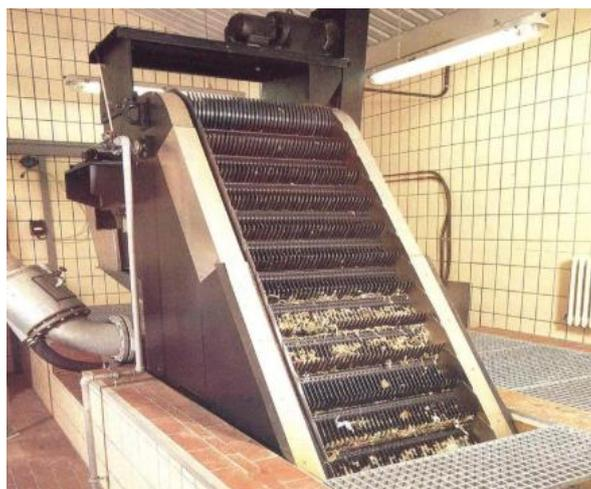
*Ilustración 3. Tamiz Deslizante. Fuente:
