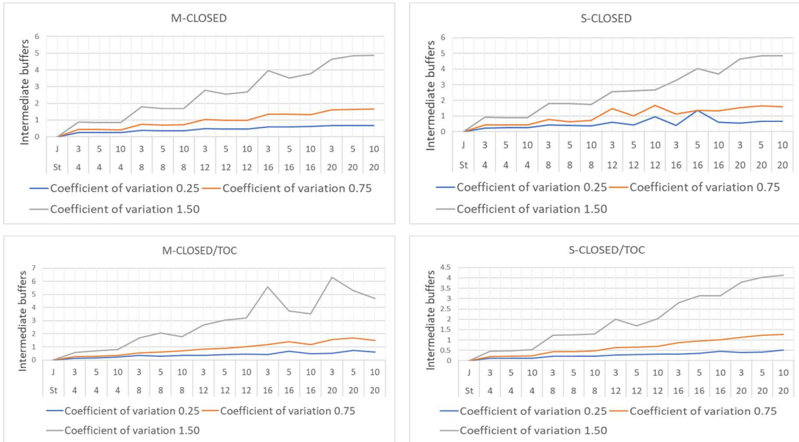
Figura 32. Niveles de los buffers frente al número de trabajos y estaciones para el entorno UNIF [1,2] [Fuente: Elaboración propia]
