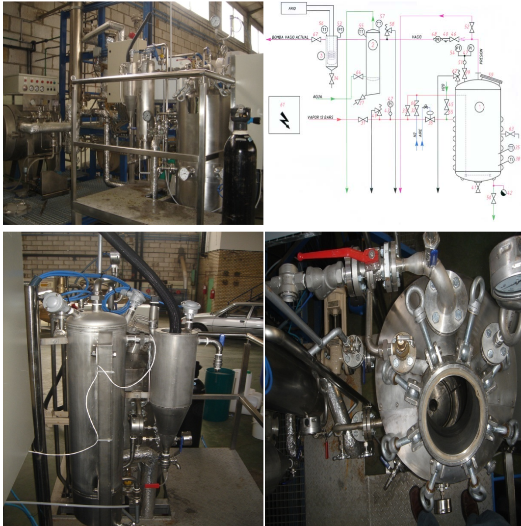
Figura 21. Fotografías y esquema del nuevo reactor de tratamiento con vapor del Departamento de Biotecnología de Alimentos del Instituto de la Grasa (C.S.I.C.), Sevilla, utilizado en el presente trabajo de investigación. En el esquema (arriba a la derecha) pueden verse todos los componentes y sistemas auxiliares del reactor. Arriba a la izquierda el reactor enclavado en la nueva bancada junto a la caldera y el reactor steam explosion. Detalle de los condensadores (abajo a la izquierda) y de la boca de carga y de las líneas de vapor, volátiles, nitrógeno, agua y aire comprimido (abajo a la derecha).
