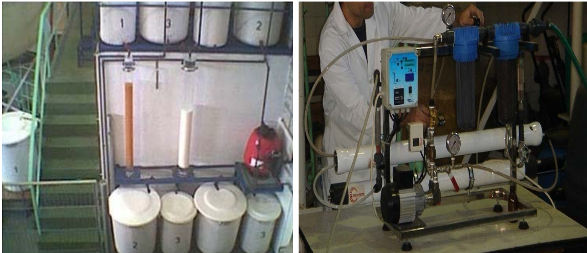
Figura 40. Fotografías de la planta piloto para la purificación de DHFG (izquierda) y del equipo de ósmosis inversa utilizado para la concentración de las fracciones purificadas (derecha).
