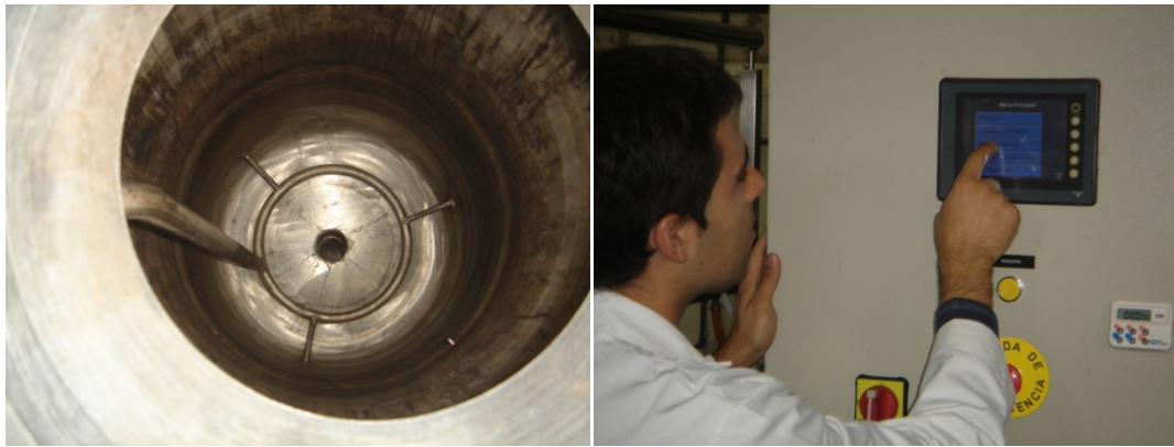
Figura 22. Fotografías del interior del cuerpo del reactor con la entrada de vapor en el fondo (izquierda) y del cuadro eléctrico y panel de operación y control (derecha) que muestra un sinóptico o menú principal que permite acceder a las funciones de control de la temperatura y la presión, con indicadores de estado de maniobra e histórico o registro de valores.
