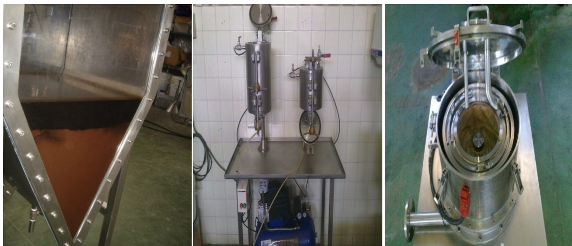
Figura 23. Fotografías (de izquierda a derecha) del depósito de decantación, en donde se observa la separación de las fases, el equipo de filtración y la centrífuga.
