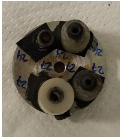
Figura 45 – Los implantes y pilares preparados con cintas de carbono para ser observados en el SEM
