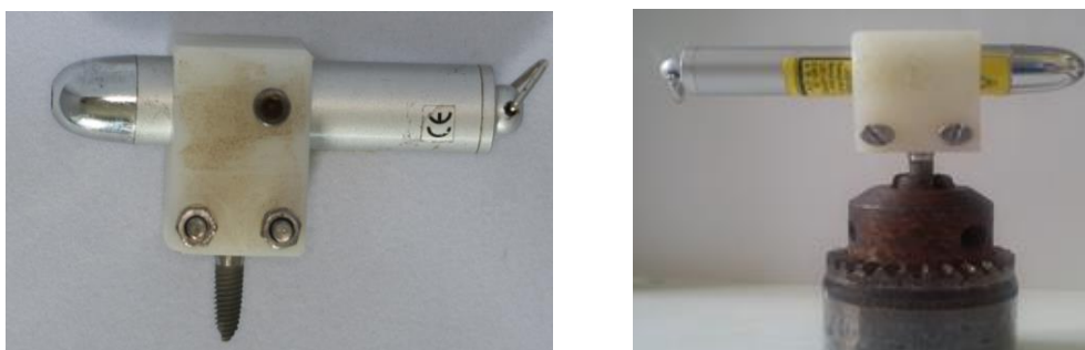
Figura 26 - Dispositivo para medir los ángulos de libertad de rotación
