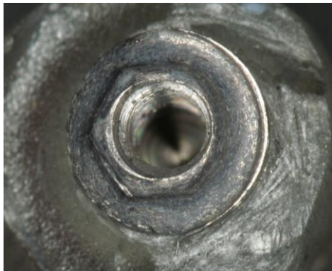
Figura 69 Fotografía digital del implante. Se observa redondeo de los vértices de los hexágonos y presencia de polvo de titanio.
