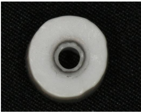
Figura 81 Fotografía digital del pilar. Se observa polvo de titanio.
