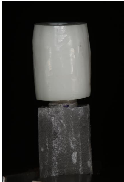
Figura 42 - El implante con un pilar de zirconio colocado en la garra inferior de la Instron 8874
