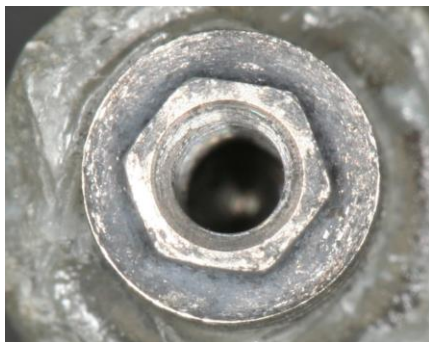
Figura 61 Fotografía digital del implante. Presencia de polvo de titanio.
