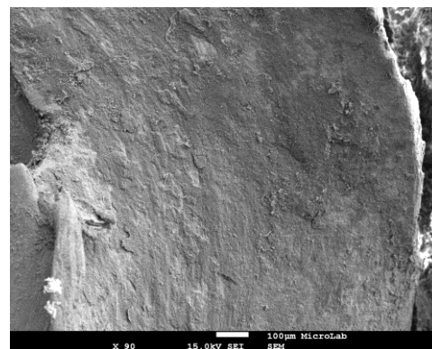
Figura 88 Fotografía de microscopia a 90 aumentos. Se observa desgaste adhesivo con oxidación y gripado, fretting, descamación, redondeo de los vértices del hexágono, con fracturas. destrucción y redondeo de la plataforma de asentamiento, con fracturas en el implante.
