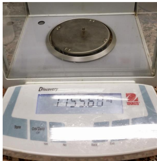
Figura 40 - Pesaje del implante incluido en soporte de resina acrílica
