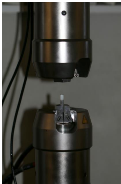
Figura 44 – Fin del ensayo, se levanta el agarre superior de la Instron 8874
