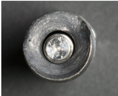
Figura 89 Fotografía digital del pilar. Se observa redondeo de los vértices del hexágono y presencia de polvo de titanio.
