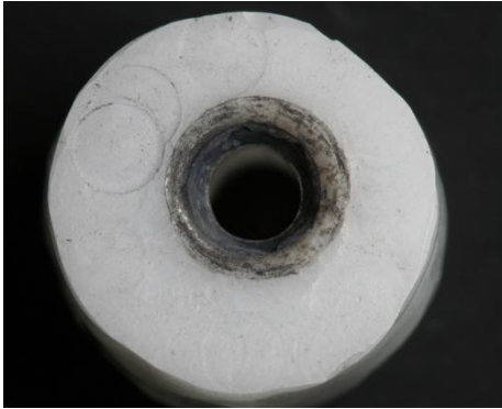
Figura 97 Fotografía digital del pilar. No se observan los vértices del hexágono ya que existe una elevada presencia de polvo de titanio.
