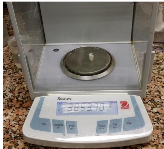
Figura 38 - Pesaje del pilar de zirconio
