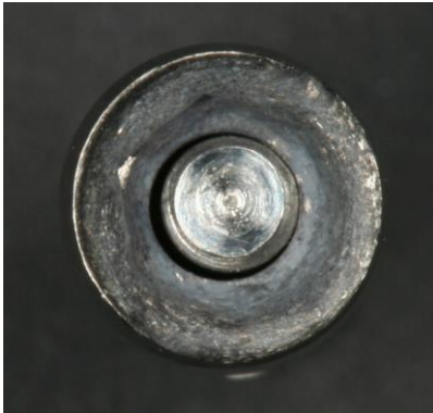
Figura 73 Fotografía digital del pilar. Se observa redondeo de los vértices de los hexágonos y presencia de polvo de titanio.
