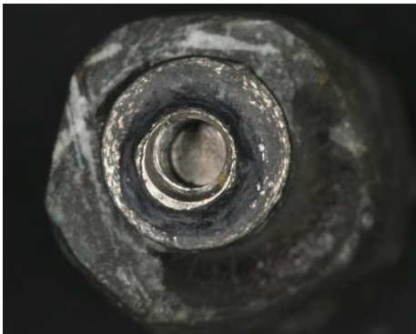
Figura 93 Fotografía digital del implante. Se observa redondeo de los vértices del hexágono y presencia de polvo de titanio.
