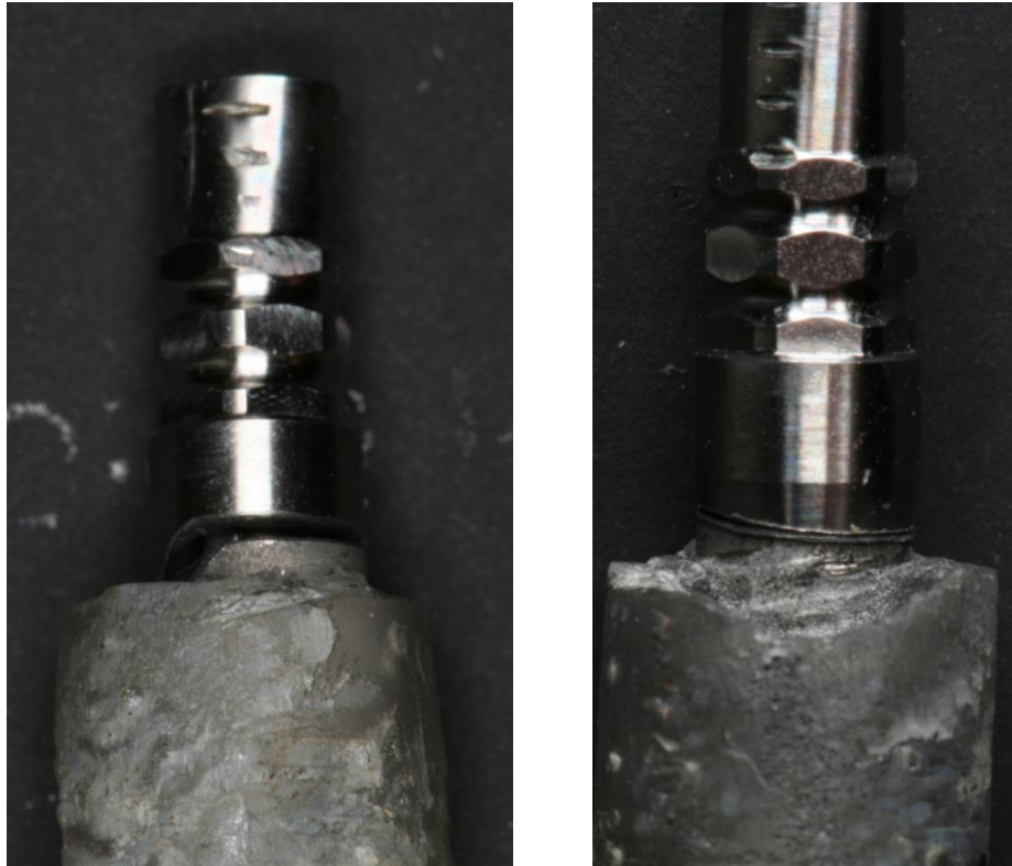
Figura 48 Pilares sueltos al finalizar el test
