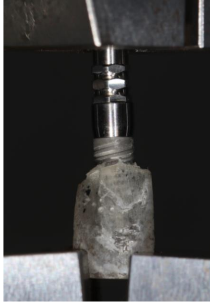
Figura 43 - El implante con un pilar de titanio colocado en la garra inferior y superior de la Instron 8874
