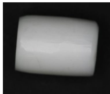
Figura 24 – Pilar de zirconio pre-sinterizado. Vista lateral
