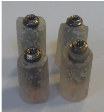
Figura 35 - Implantes en soporte de resina acrílica
