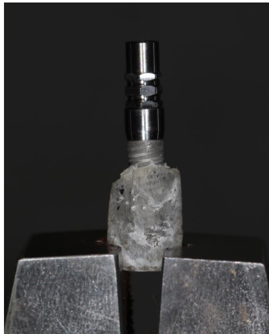
Figura 41 - El implante con pilar de titanio colocado en la garra inferior de la Instron 8874
