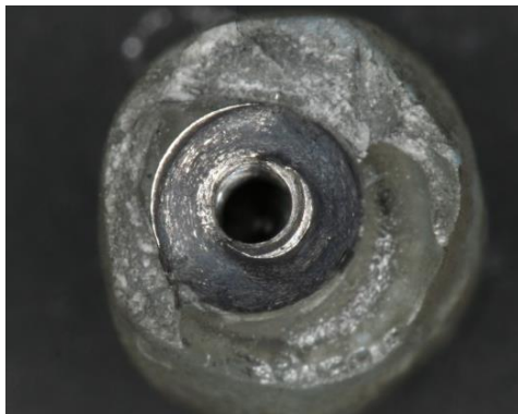
Figura 85 Fotografía digital del implante. Se observa redondeo de los vértices del hexágono y presencia de polvo de titanio.
