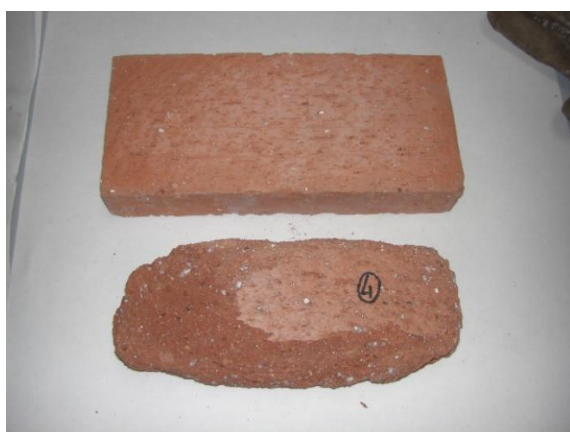
Fig. 37 - Perdida de material del LM nº 4
