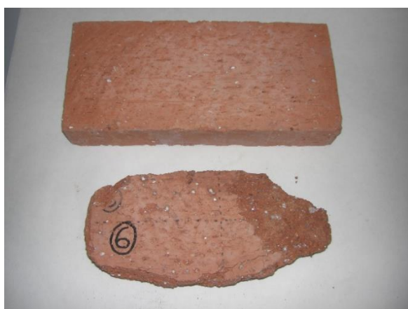
Fig. 39 - Perdida de material del LM nº 6
