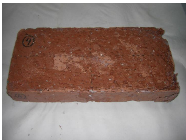
Fig. 29 - Disgregación del LM nº 4
