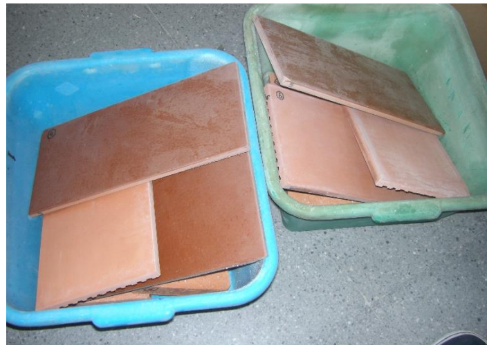
Fig. 21 – Blanqueamiento de muestras en ensayo de Heladicidad
