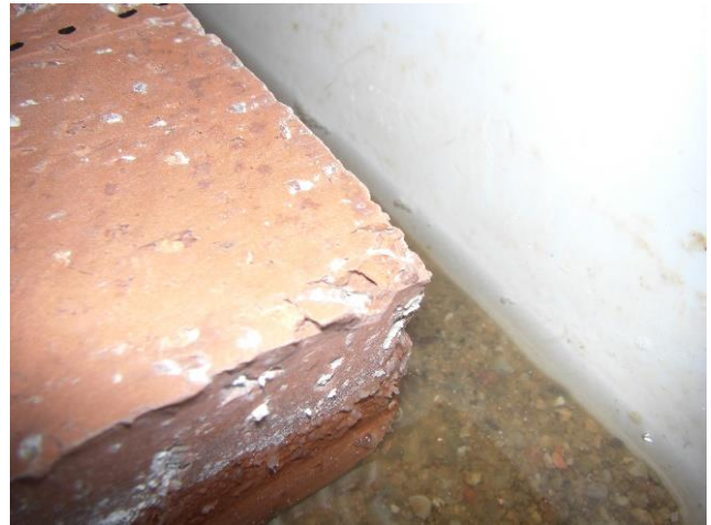
Fig. 23 – Descascarillamiento de los bordes del LM nº 3
