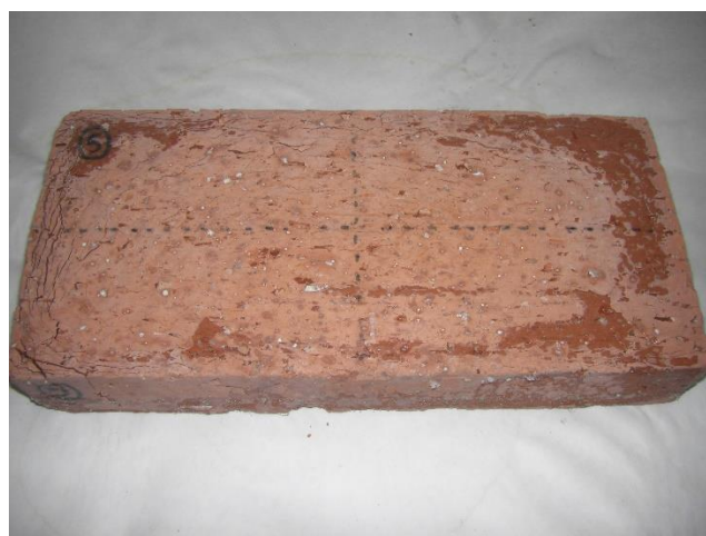
Fig. 30 - Disgregación del LM nº 5
