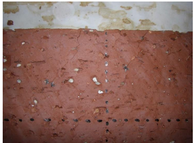
Fig. 25 – Fisuración de las muestras de LM 4, 5 y 6
