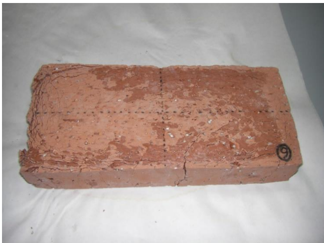
Fig. 31 – Disgregación del LM nº 6
