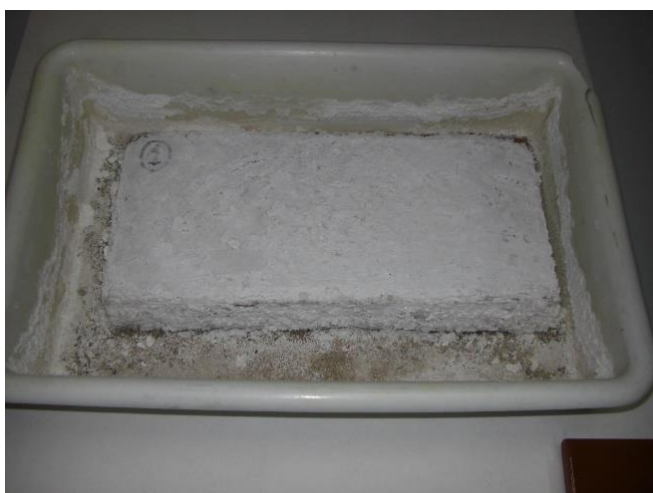
Fig. 26 – Volumen de eflorescencias al segundo ciclo de la tercera fase
