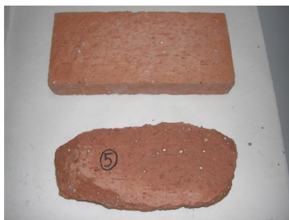
Fig. 38 - Perdida de material del LM nº 5
