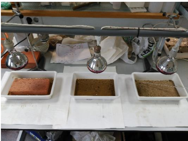
Fig. 12 - Preparación del Ensayo de Cristalización de sales
