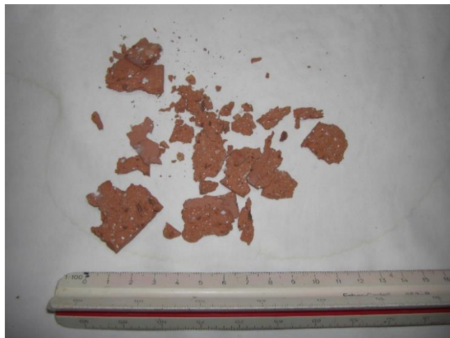
Fig. 32 – Material disgregado
