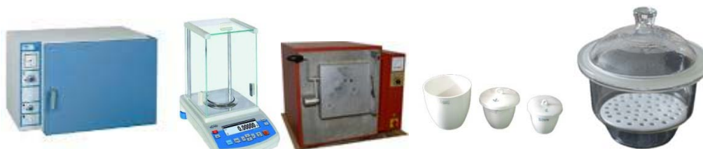
Figura 2.1.- Equipos utilizados para la determinación de ST y SV.
