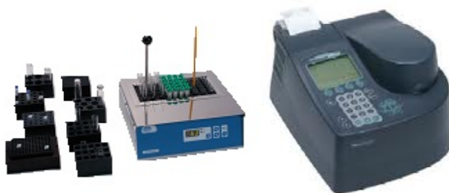
Figura 2.5.- Equipos utilizados para la determinación de CODs.
