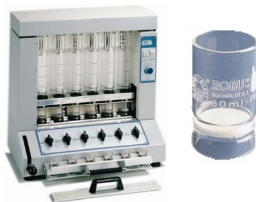
Figura 2.3.- Equipo utilizado para la determinación del contenido en fibra.
