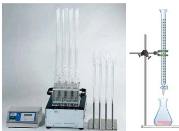
Figura 2.2.- Equipos utilizados para la determinación de la CODt
