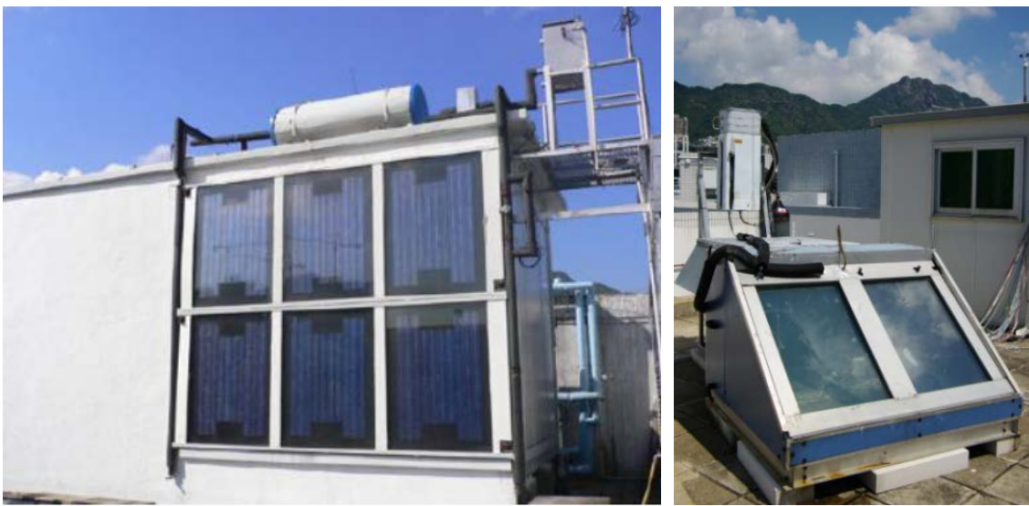
Fig. 31 y Fig. 32: Modelos en creados en Hong Kong para el estudio de resultados. Modelos con vidrios verticales e inclinados. (Li 2012)
