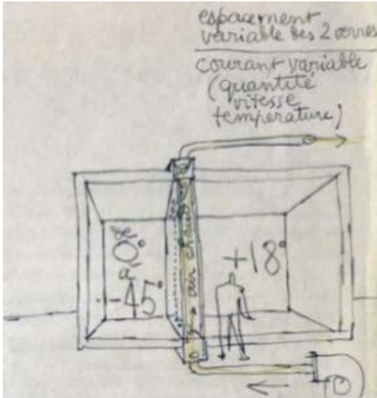
Fig. 04: Esquema descriptivo el muro neutralizante (Le Corbusier 1928)
