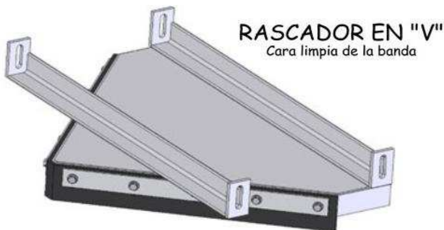
Fig. 5.15.- Rascador en “V”.
