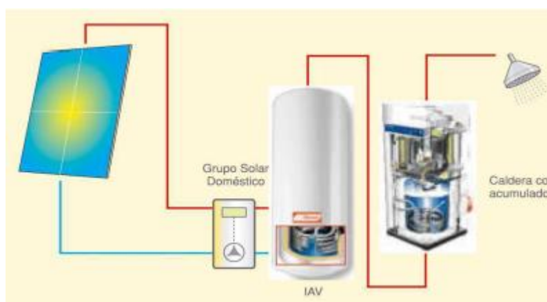
Fig. 1: esquema simplificado de instalación ACS con equipo auxiliar de energía
