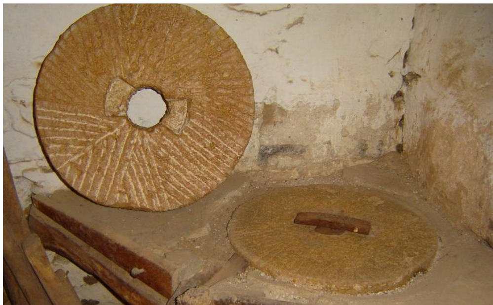
Figura 24: Muela corredera y solera
