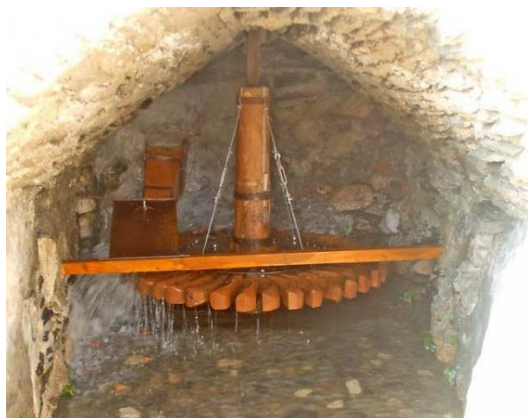
Figura 22: Eje y rodezno del molino
