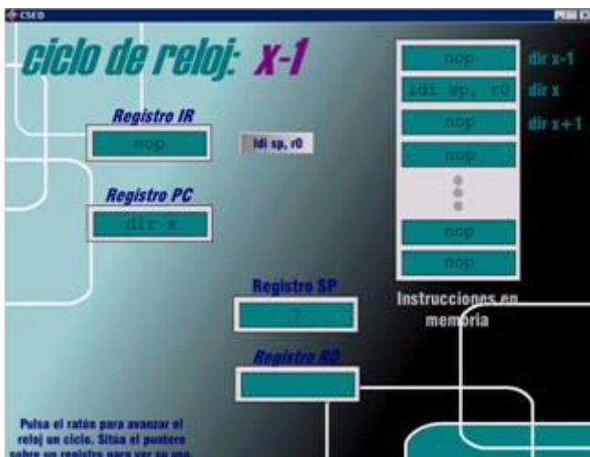
Figura 7. Modo de direccionamiento a registro.
