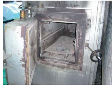
Fig. 21: Cordón textil para aislamiento de horno
