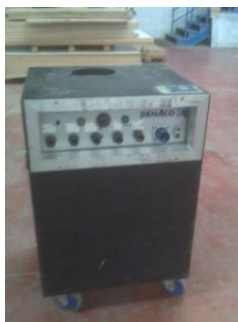
Figura 37: Equipo compacto de depósito, impulsión y succión de agua
