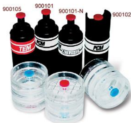
Figura 52: Tipos de filtros para muestreo de fibras de amianto
