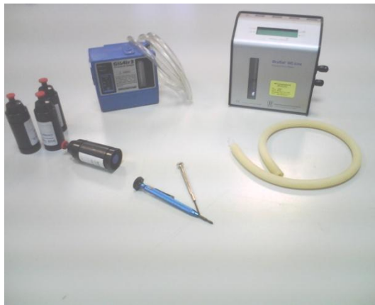
Figura 50: Filtros cassettes, bomba de muestreo, calibrador electrónico y elementos auxiliares
