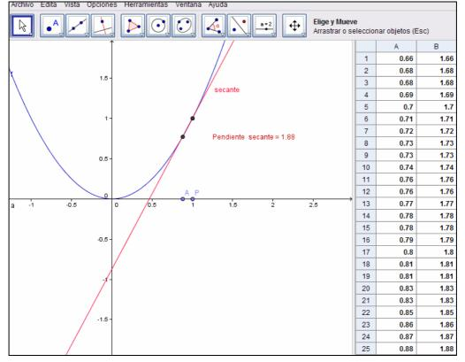
En la tarea diseñada, cuando el punto A coincide con el punto P la recta secante se convierte en la recta tangente. Haciendo "visible" la tangente como límite de las rectas secantes y la pendiente.
