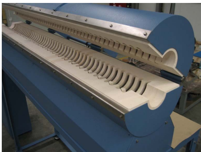
Fig.2.4. Horno eléctrico donde se sitúa el reactor de reformado en la planta experimental de SCWR.
