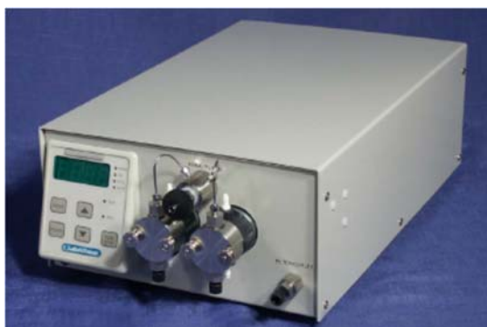
Fig.2.3. Bomba HPLC empleada en la experimentación del proceso SCWR.
