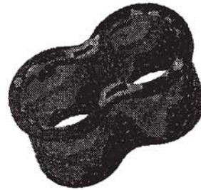
Figura 7. Campo de tensiones de la camisa del nuevo modelo.
